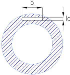
Le provette prismatiche di sezione  $axb \times l$  (lunghezza) indicate nelle normative citate, devono essere ricavate per asportazione meccanica della parte tratteggiata avendo cura che l'ultima fase di lavorazione sia una rettifica refrigerata di 0.5 mm per lato sulle superfici di dimensioni  $axl$ .
