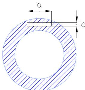
Le provette prismatiche di sezione  $a \times b \times l$  (lunghezza) indicate nelle normative citate, devono essere ricavate per asportazione meccanica della parte tratteggiata avendo cura che l'ultima fase di lavorazione sia una rettifica refrigerata di 0.5 mm per lato sulle superfici di dimensioni  $a \times l$ .
