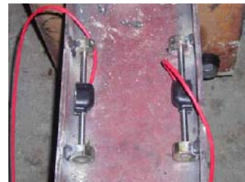
Particolare sensore a corda vibrante per acciaio
