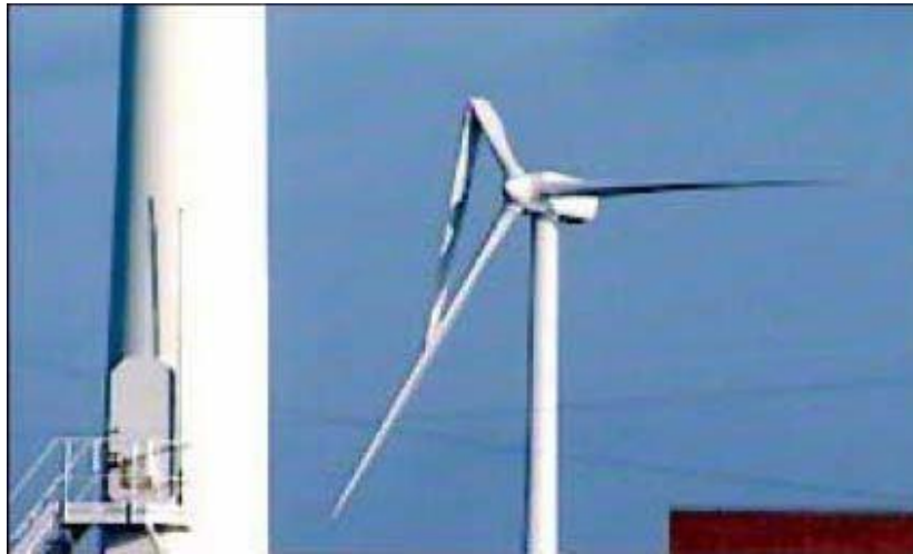
Figura 4 Esempio di rottura di pala senza distacco
