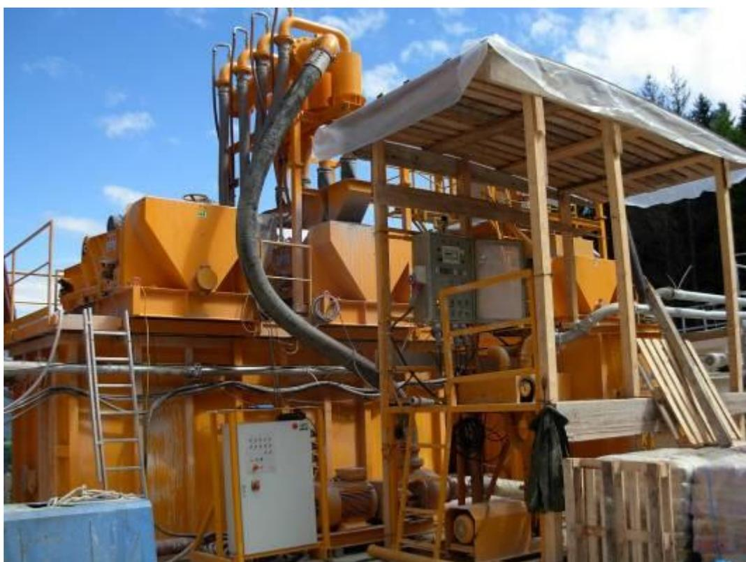
Fig. 3-17: Sistema di disidratazione
