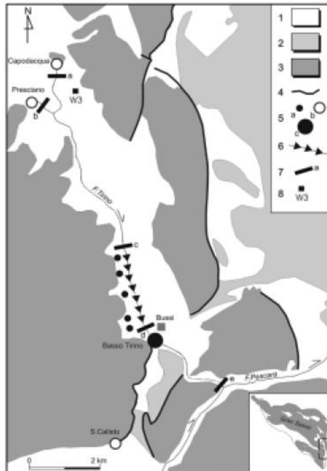
Figura 6: Schema idrologico della Valle del Tirino. 1) depositi continentali quaternari (aquitardo); 2) depositi terrigeni miocenici; 3) rocce carbonatiche meso-cenozoiche (acquifero regionale); 4) faglie e sovrascorrimenti di interesse idrogeologico; 5) sorgenti con portata (a) inferiore a 0,1 \text{ m}^3\text{s}^{-1} , (b) compresa tra 1 e 5 \text{ m}^3\text{s}^{-1} e (c) maggiore di 5 \text{ m}^3\text{s}^{-1} ; 6) sorgente lineare; 7) sezioni di misura di portata in alveo (fig. 6): a) Capodacqua, b) Presciano, c) Tirino intermedio, d) Tirino a Bussi, e) Tirino totale; 8) Pozzo monitorato.
