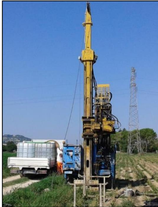
Figura 3: Perforatrice CMV MK 900 su trattore Landini
