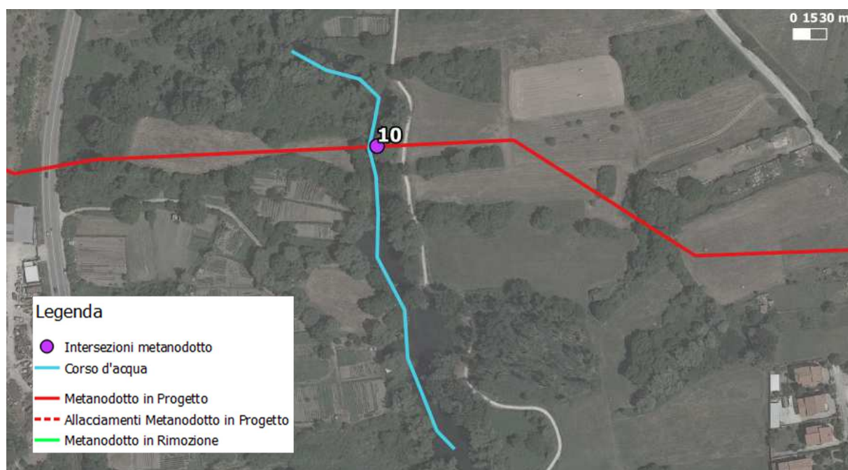
Figura 1: Vista planimetrica della zona dell'attraversamento, del tracciato del metanodotto di progetto ed esistente e del corso d'acqua.
