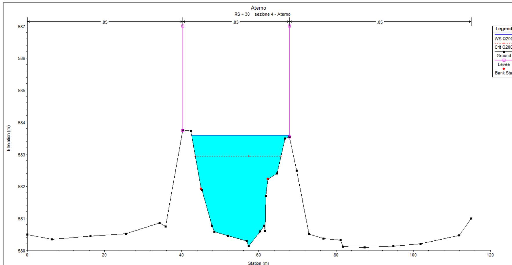
Figura 7: **RS=30** - Sezione trasversale a valle dell'attraversamento n. 15 del nuovo metanodotto – stato di progetto
