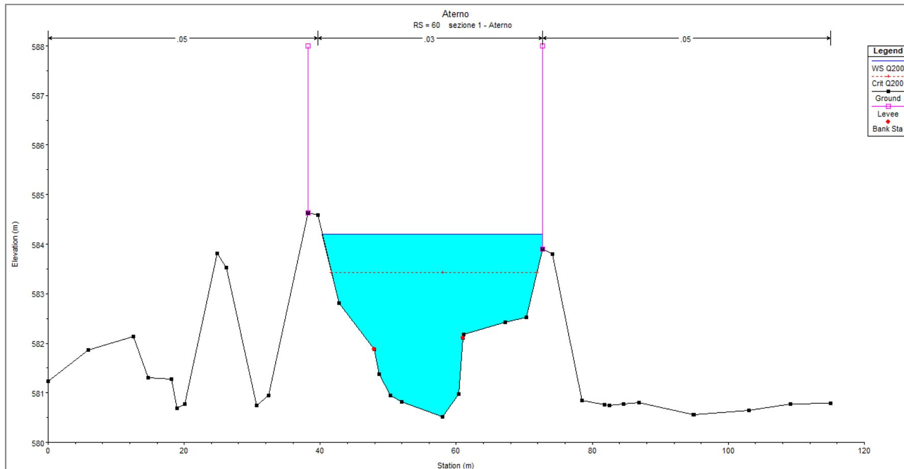
Figura 10: **RS=50** - Sezione trasversale a monte dell'attraversamento n. 15 del nuovo metanodotto – stato di progetto
