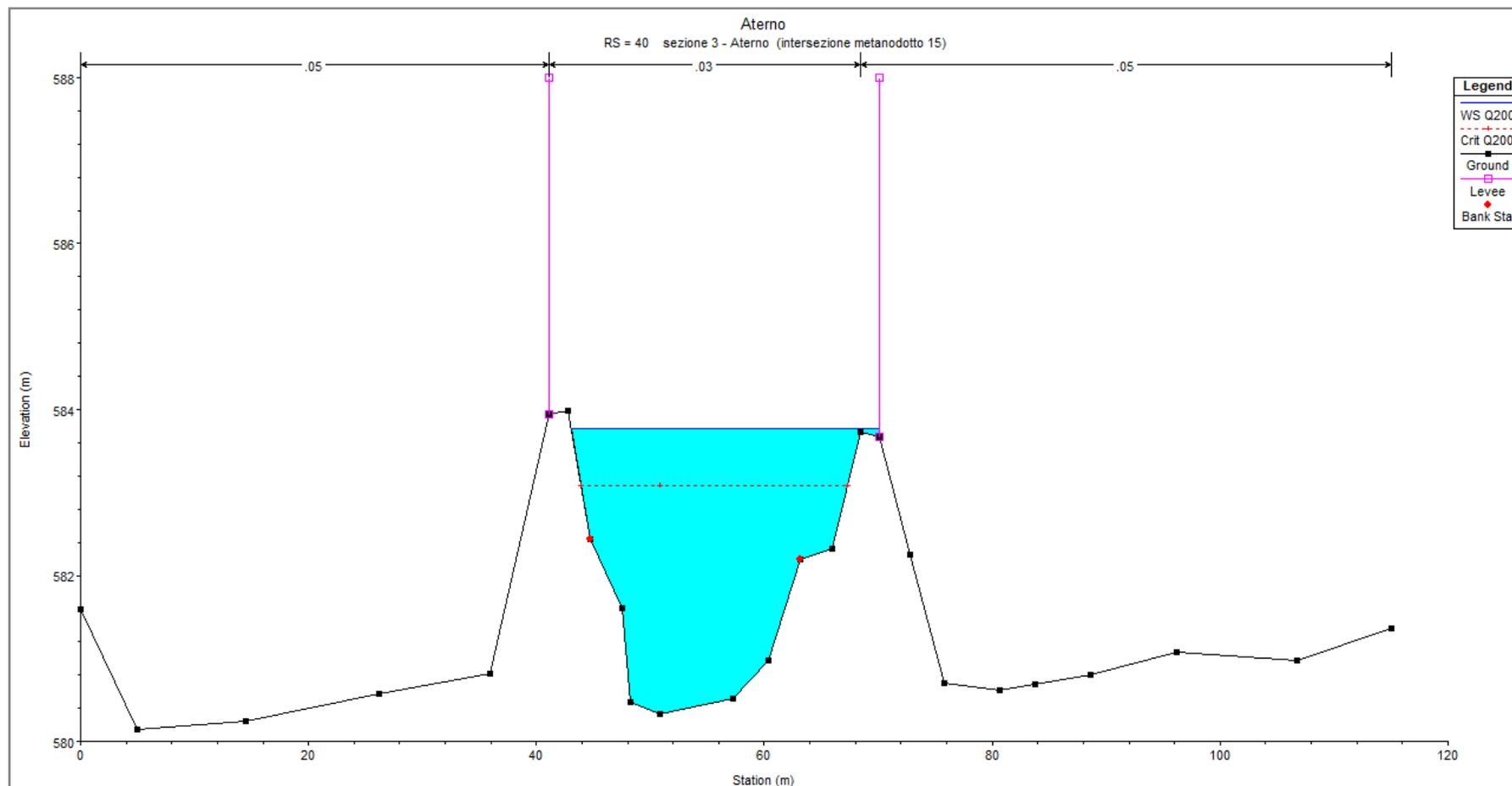
Figura 8: **RS=40** - Sezione trasversale in corrispondenza dell'attraversamento n. 15 del nuovo metanodotto – stato di progetto
