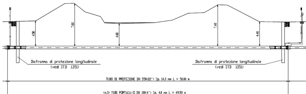
Figura2: Attraversamento dell'Aterno (n.15) - Sezione schematica di progetto
