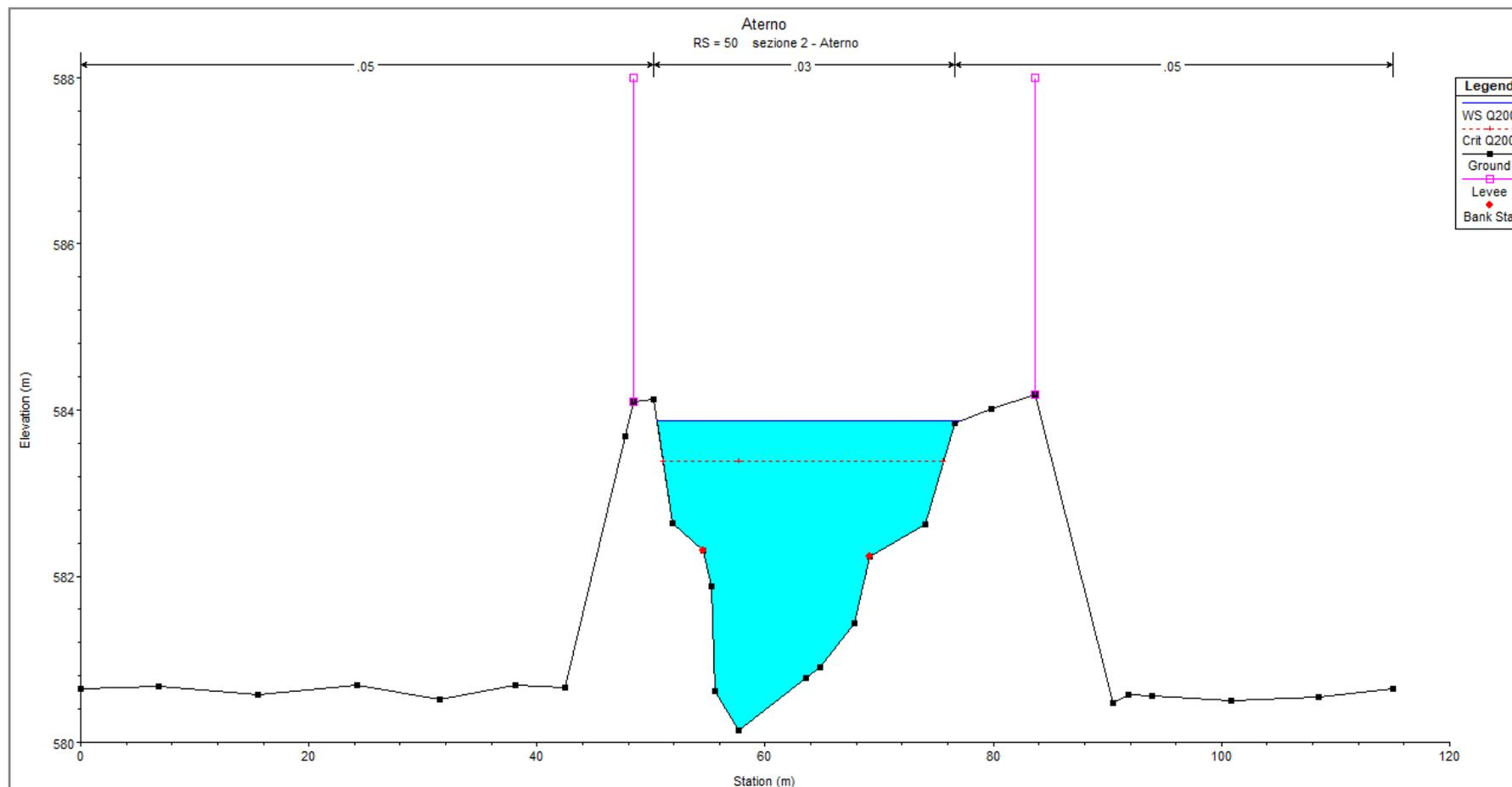
Figura 9: **RS=50** - Sezione trasversale a monte dell'attraversamento n. 15 del nuovo metanodotto – stato di progetto
