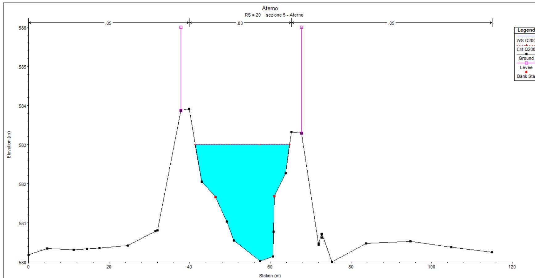
Figura 6: **RS=20** - Sezione trasversale a valle dell'attraversamento n. 15 del nuovo metanodotto – stato di progetto
