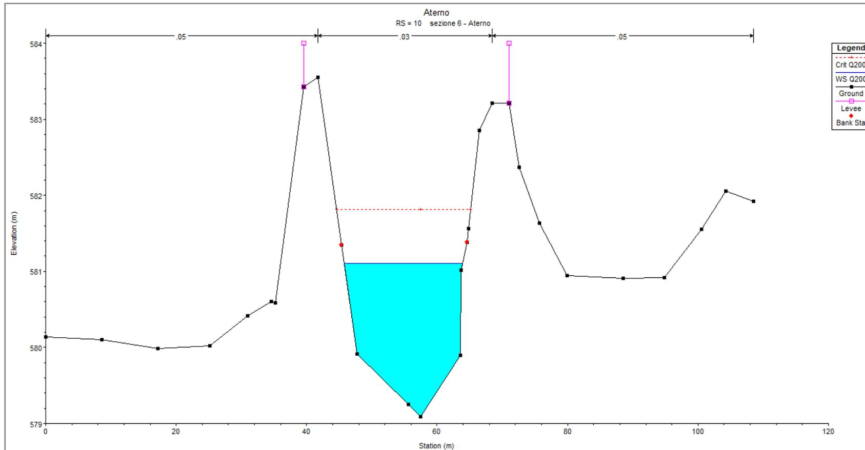
Figura 5: **RS=10** - Sezione trasversale a valle dell'attraversamento n. 15 del nuovo metanodotto – stato di progetto
