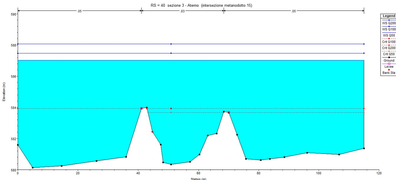
Figura 4: Risultato della modellazione in HEC-RAS per la sezione in corrispondenza dell'attraversamento nel caso di portate con tempo di ritorno pari a 50, 100 e 200 anni
