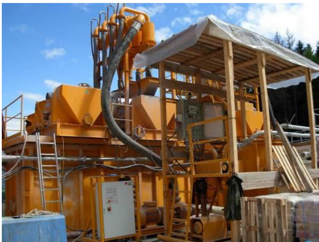
Fig. 6-23 - Sistema di disidratazione.
