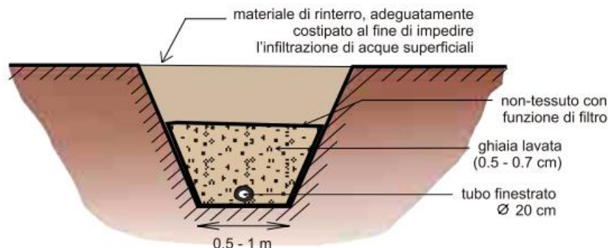
Fig. 7-16 - Trincea drenante sotto condotta.
