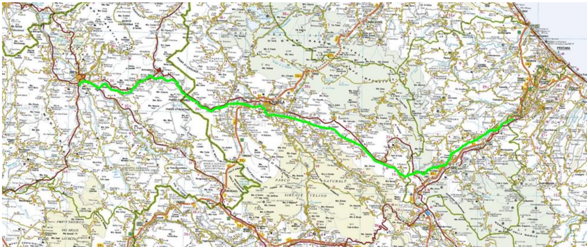
Fig. 1.1 - Inquadramento generale delle opere in rimozione identificate con linea verde: Metanodotto Chieti - Rieti DN 400 (16") MOP 64 bar" e delle opere connesse
