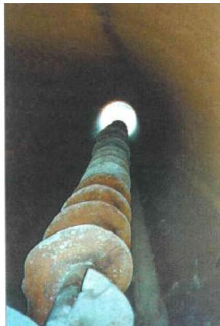
**Fig. 2.5 - Coclea per trivella spingitubo.**
