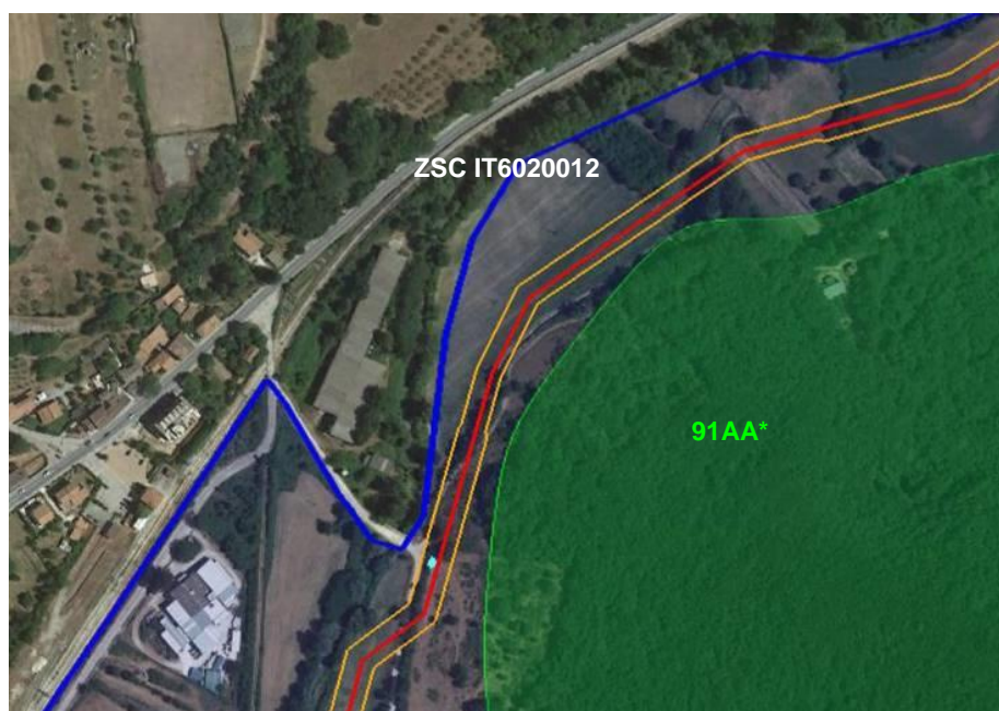
Figura 4-15: estensione delle aree di occupazione lavori (linee arancioni) per la realizzazione del nuovo metanodotto principale in progetto (linea in rosso) all'interno della ZSC IT6020012 (area in blu). Analisi di prossimità con l'estensione del querceto riconducibile all'habitat 91AA*, individuato sulla base della Carta della Natura ISPRA (biotopo cod. 41.732). Evidente assenza di interferenze dirette con le superfici boscate asseribili a questo habitat.
