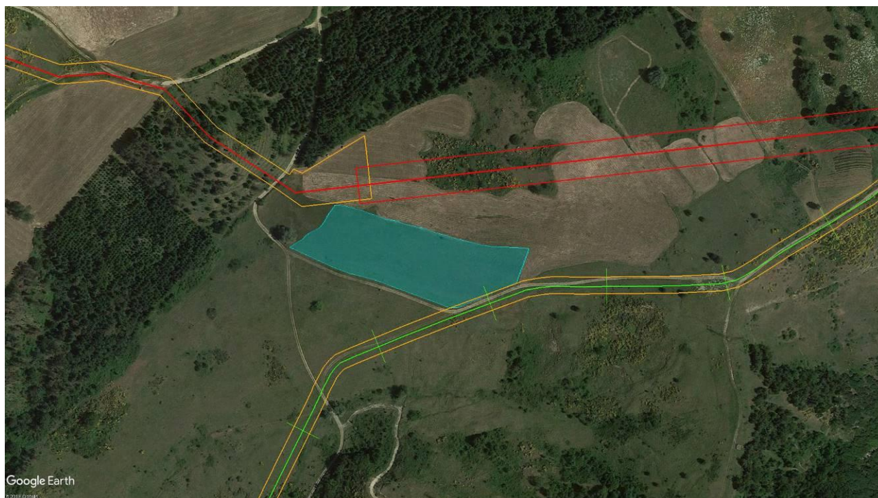
Figura 4-35: potenziale habitat 6210(*) identificato in sede di rilievi fitosociologici e sviluppo delle opere in progetto (rosso) con trenchless e asse del metanodotto in dismissione (verde), e delle relative aree di occupazione lavori (linee in arancione). Le superfici dei cantieri non ricadono all'interno dell'habitat che non subirà alcun tipo di interferenza diretta.
