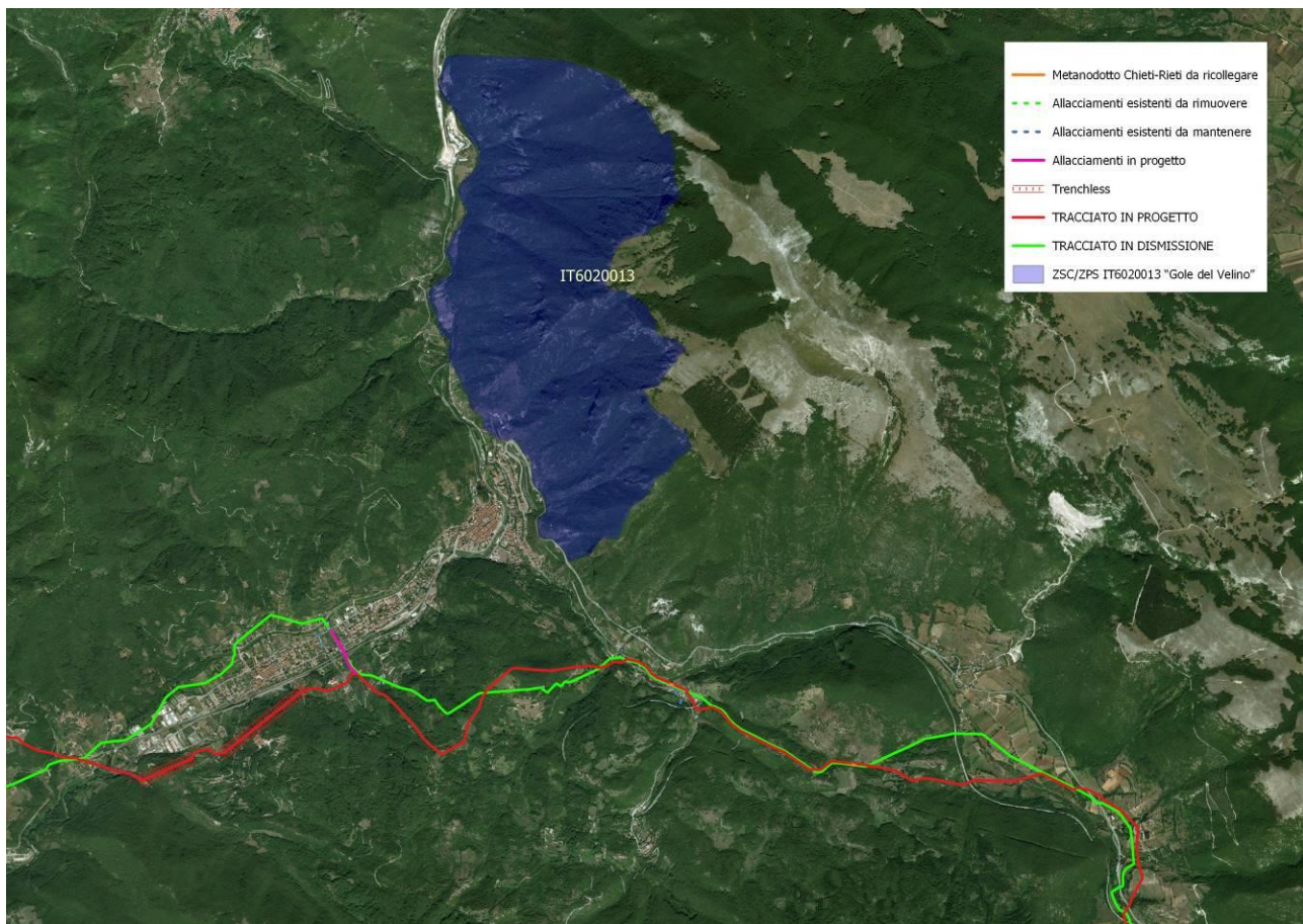
Figura 4-6: ZSC/ZPS IT6020013 "Gole del Velino" e interazione con le opere in progetto e in rimozione.
