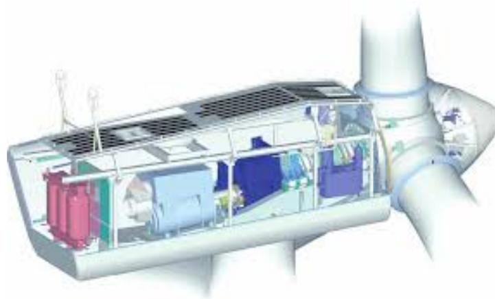
Fig. 56 - Elementi di una navicella
