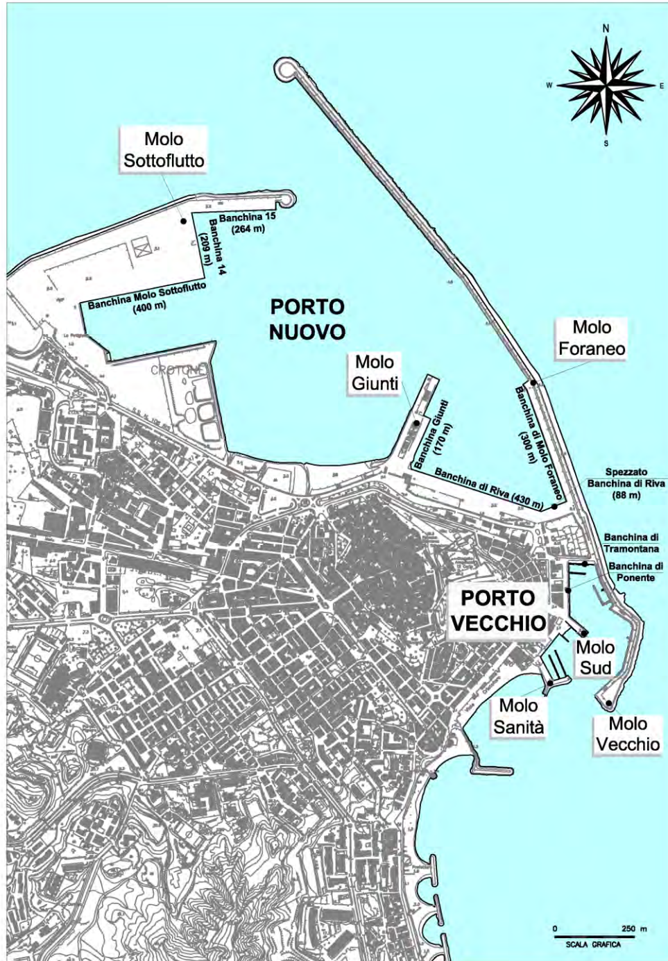
Figura 3: Schema del porto di Crotona
