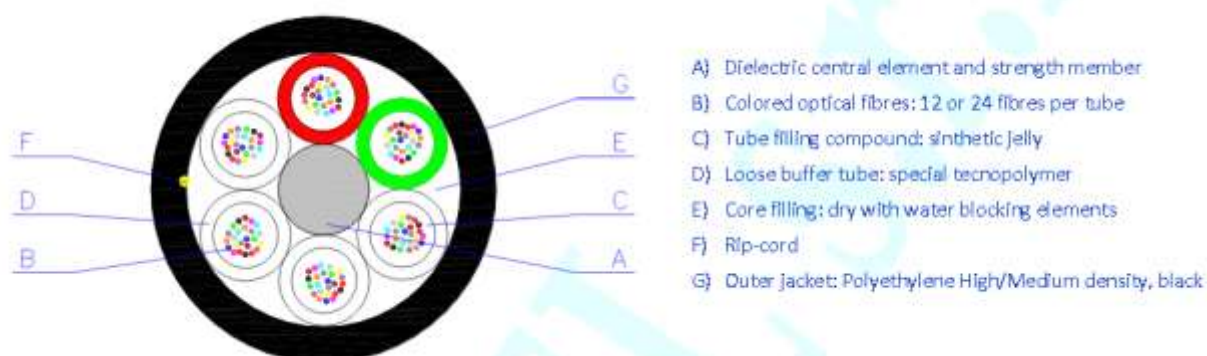
Figura 5-1 Minicavi in fibroattica entro minitubi
