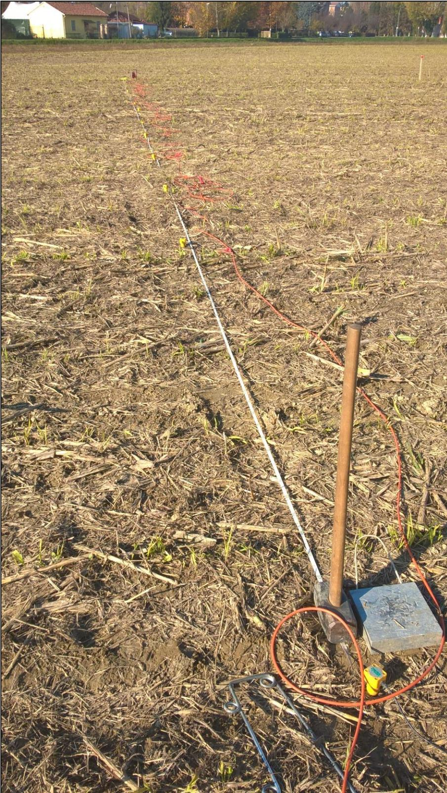
Infissione nel terreno di geofoni per acquisizione Vs30 (stendimento sismico MASW 2)
