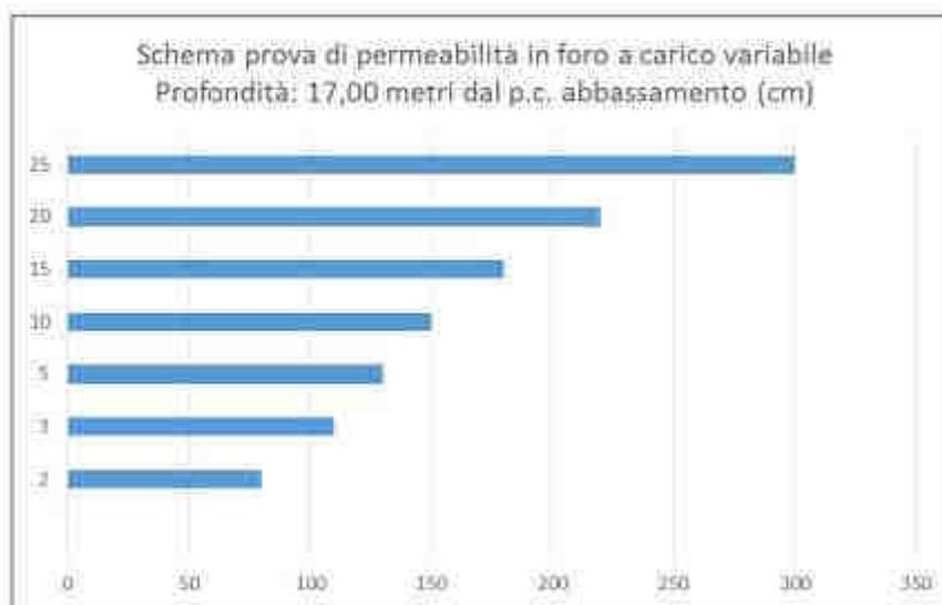
Nell'arco di tempo (t1-t2) da 2 a 25 min, il livello idrico nel foro di sondaggio si è abbassato di 220 cm.
