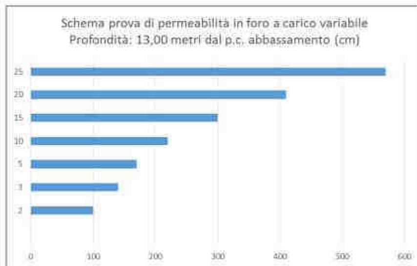
Nell'arco di tempo (t1-t2) da 2 a 25 min, il livello idrico nel foro di sondaggio si è abbassato di 470 cm.
