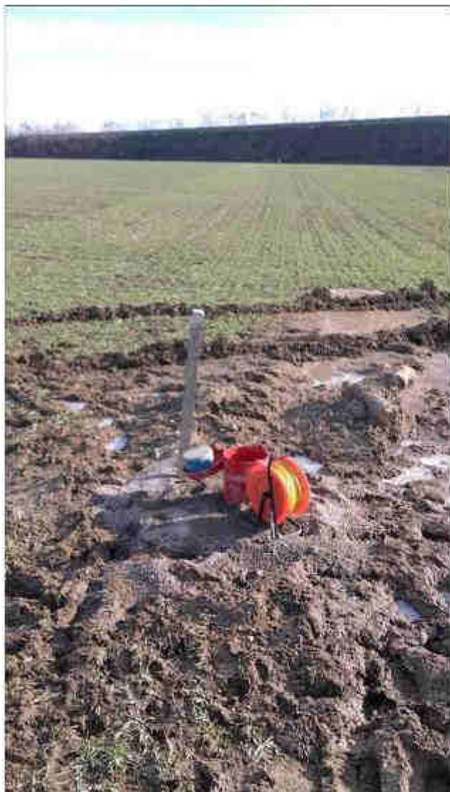
Chiusino piezometro (misura freaticometrica livella falda piezometro)
