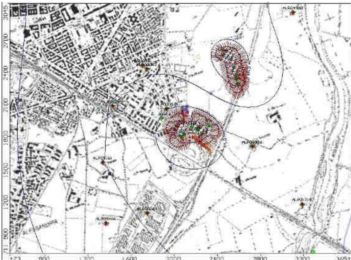
In fig. 1.1-2 si riporta la rappresentazione delle pathlines a 182 giorni, rappresentanti il fronte di alimentazione dei pozzi in emungimento (pathlines convergenti, dimensioni di circa 380 m x 540 m) e il fronte di alimentazione dell'acquifero da parte dei pozzi (pathlines divergenti, dimensioni di circa 300 m x 560 m).
