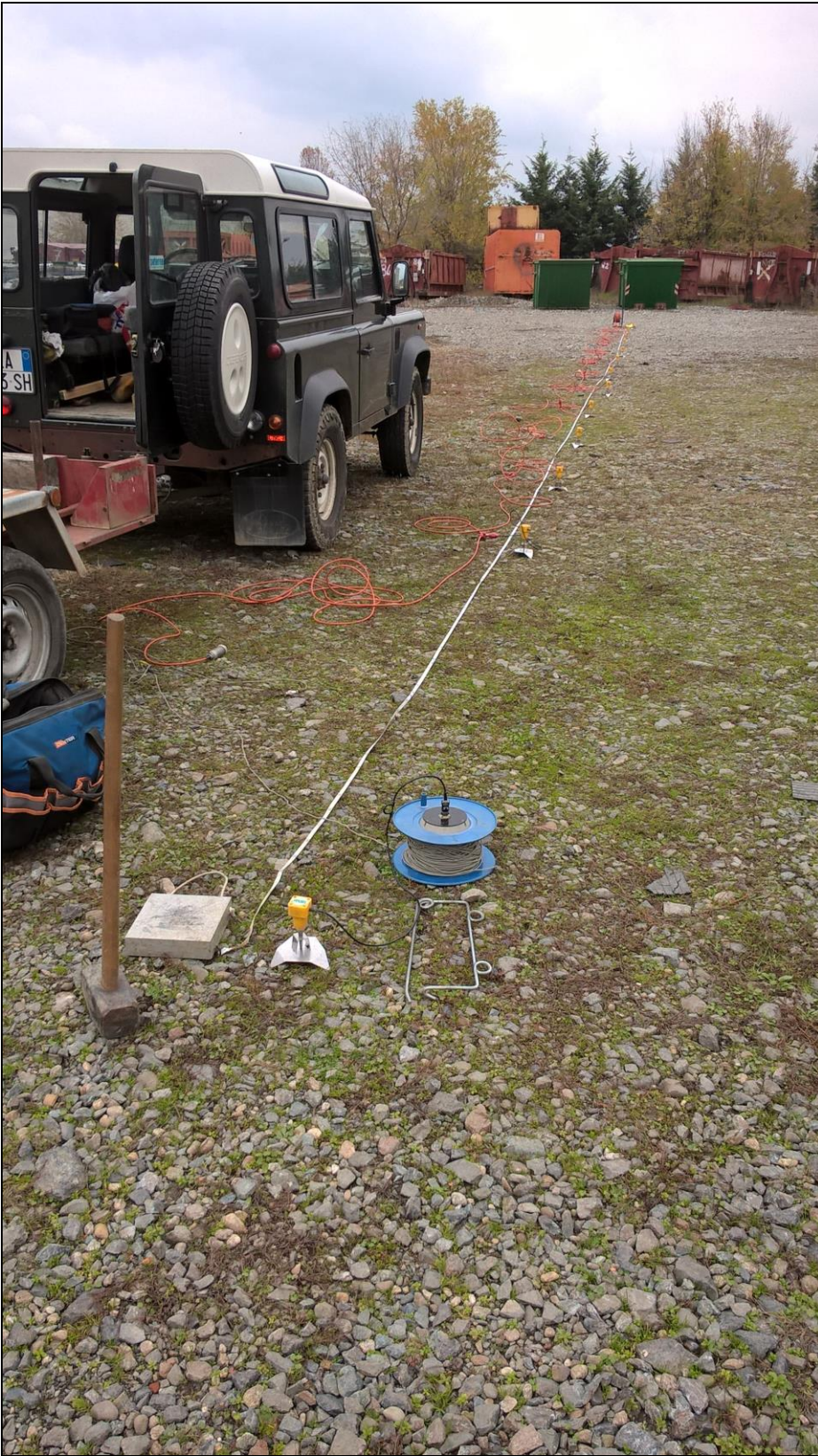
Infissione nel terreno di geofoni per acquisizione Vs30 (stendimento sismico MASW)
