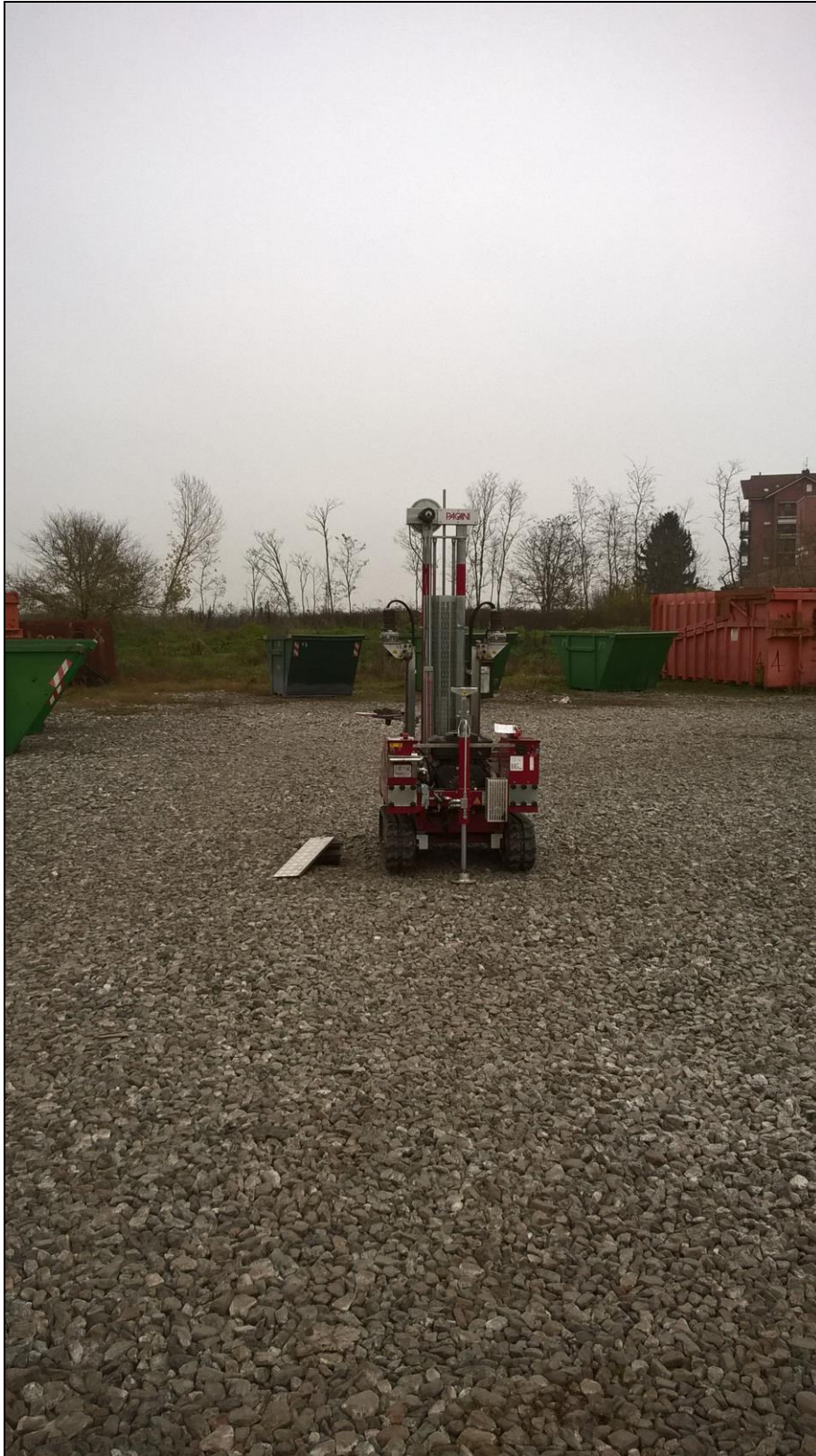
Penetrometro dinamico PAGANI TG-63 -100 Kn Centrale EGEA IN PROGETTO Comune di Alessandria PIAZZALE A.M.A.G. in fregio a Via Pasino e campo sportivo
