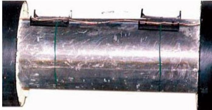
**Figura 6-2 Collegamento dei fili all'interno del giunto**
