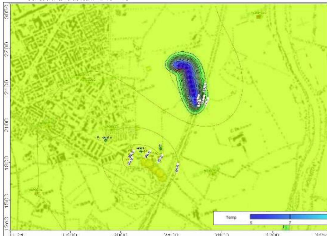
**Andamento della riduzione della temperatura dell'acqua di falda a 30 mesi; temperatura espressa in °C**
