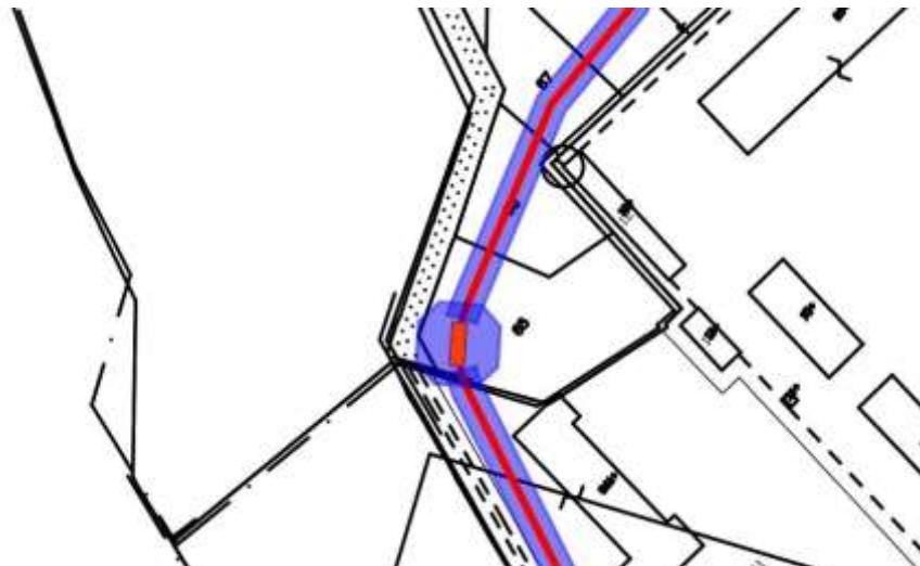
Figura 3.4-8 Buca giunti situata a valle area vigili, inquadramento su mappa catastale con DPA
