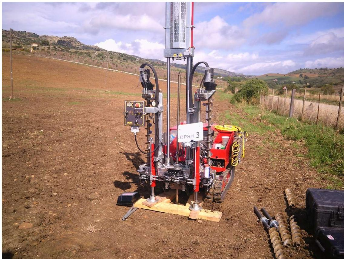
**PROVA PENETROMETRICA DINAMICA DPSH 3**
