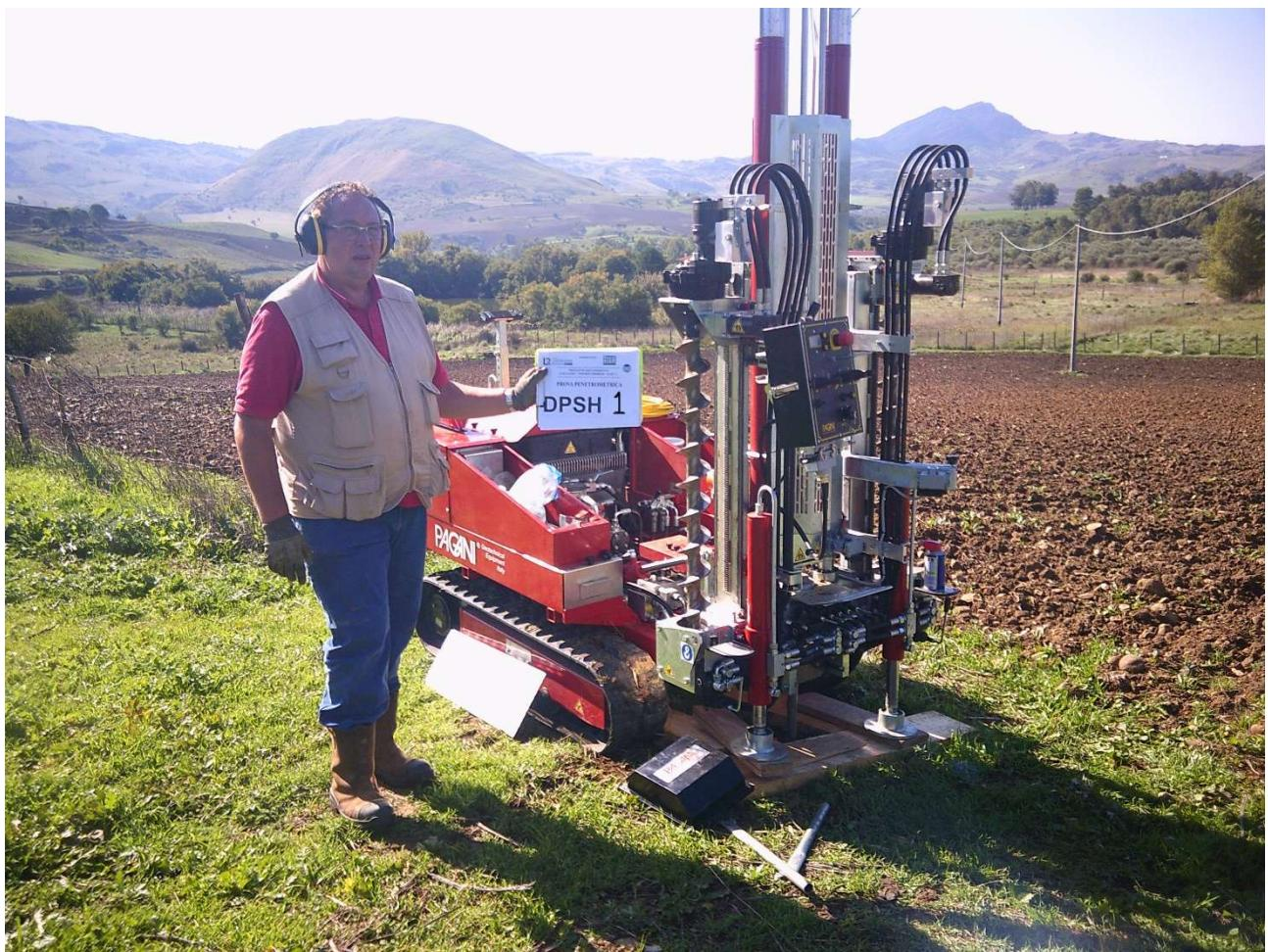
**PROVA PENETROMETRICA DINAMICA DPSH 1**
