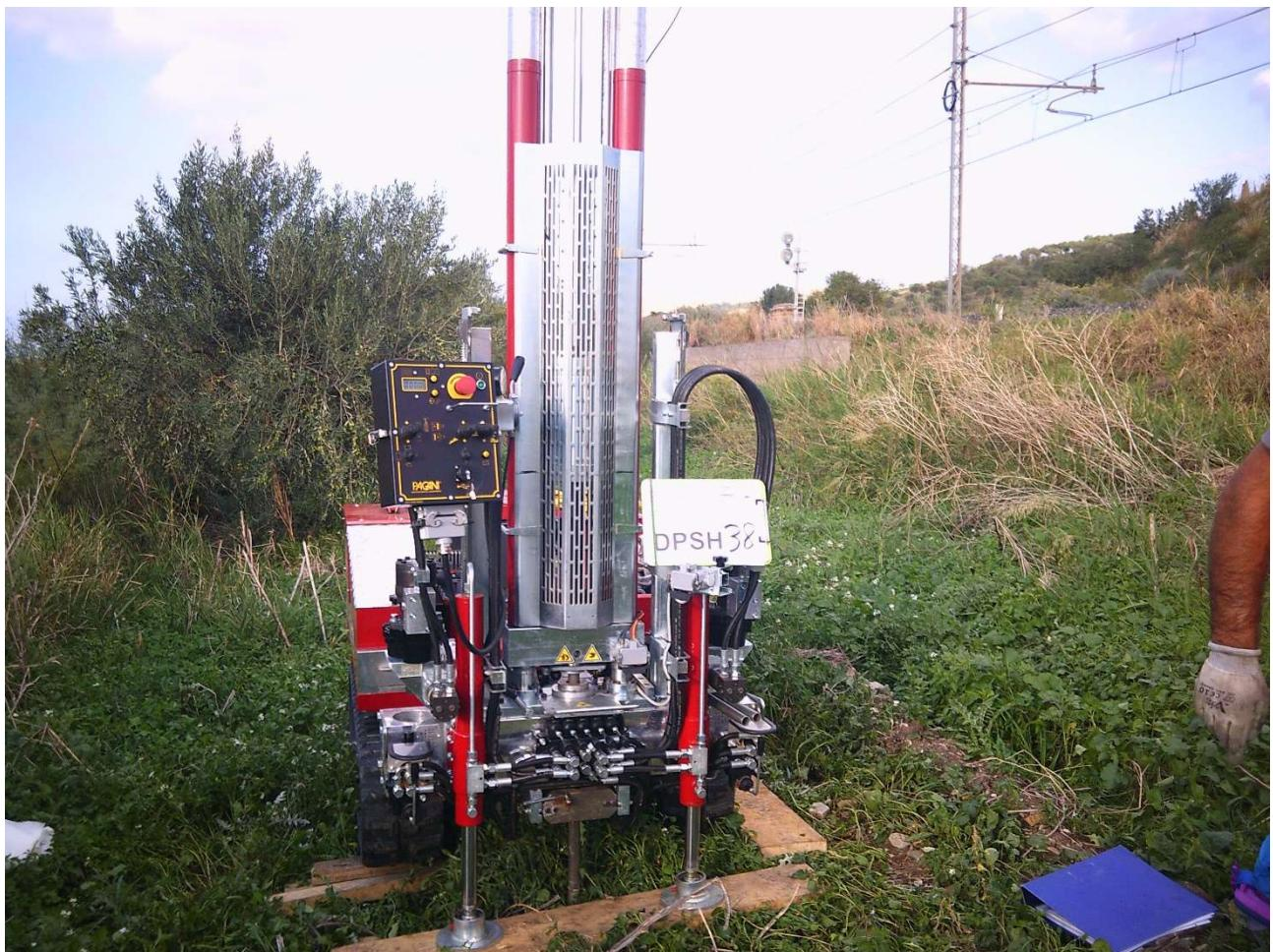
**PROVA PENETROMETRICA DINAMICA DPSH 38**
