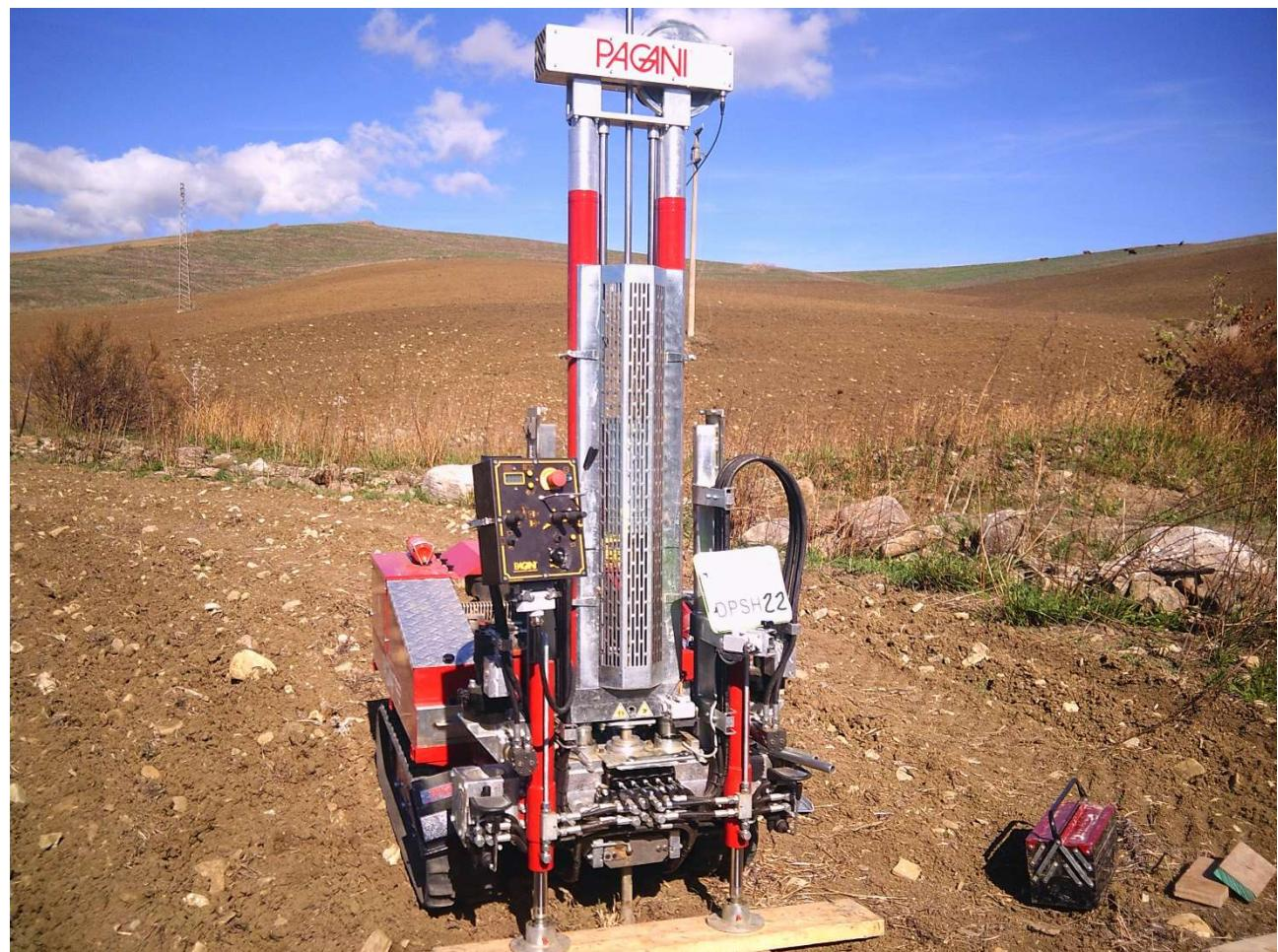
**PROVA PENETROMETRICA DINAMICA DPSH 22**
