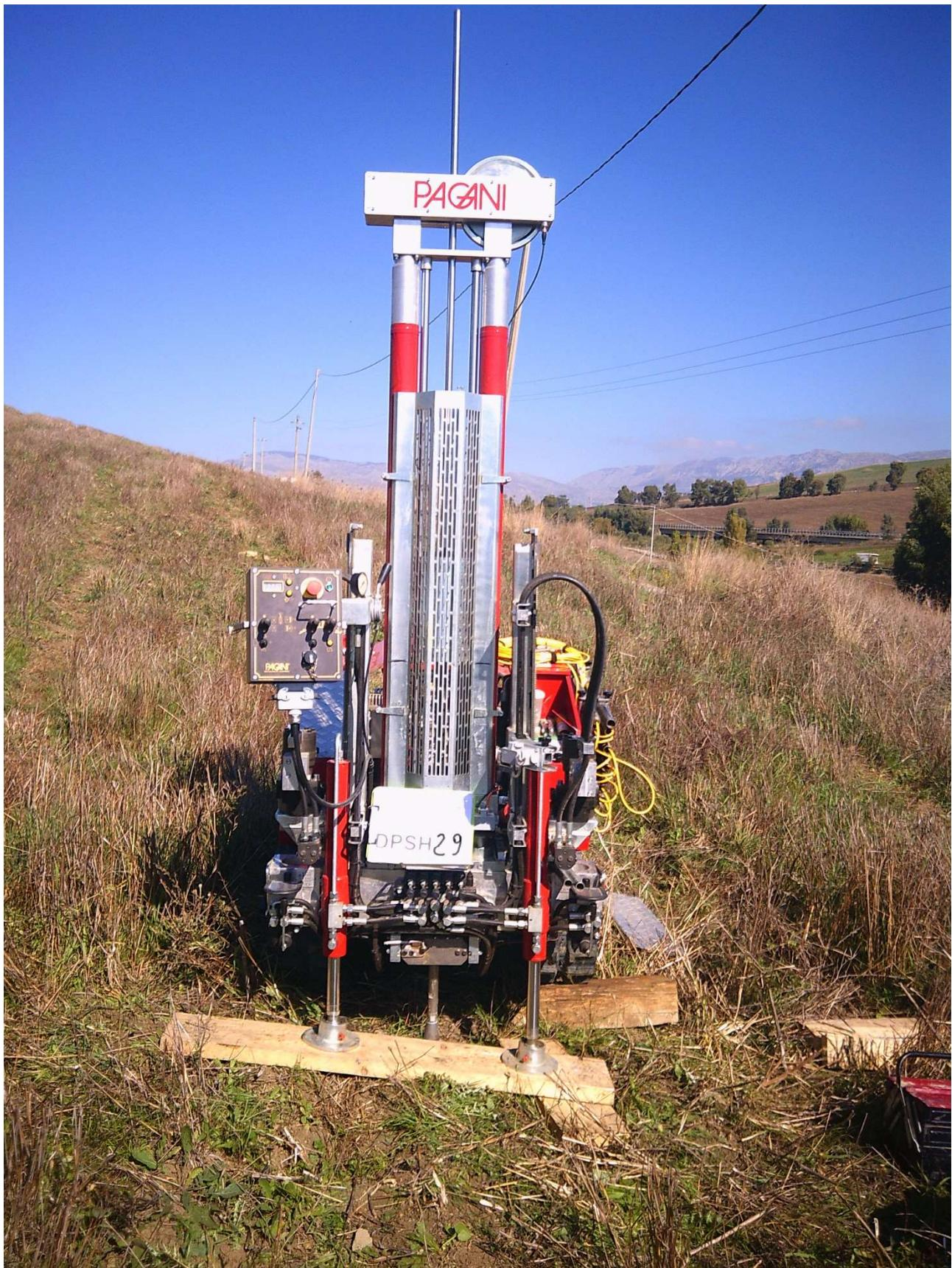
**PROVA PENETROMETRICA DINAMICA DPSH 29**
