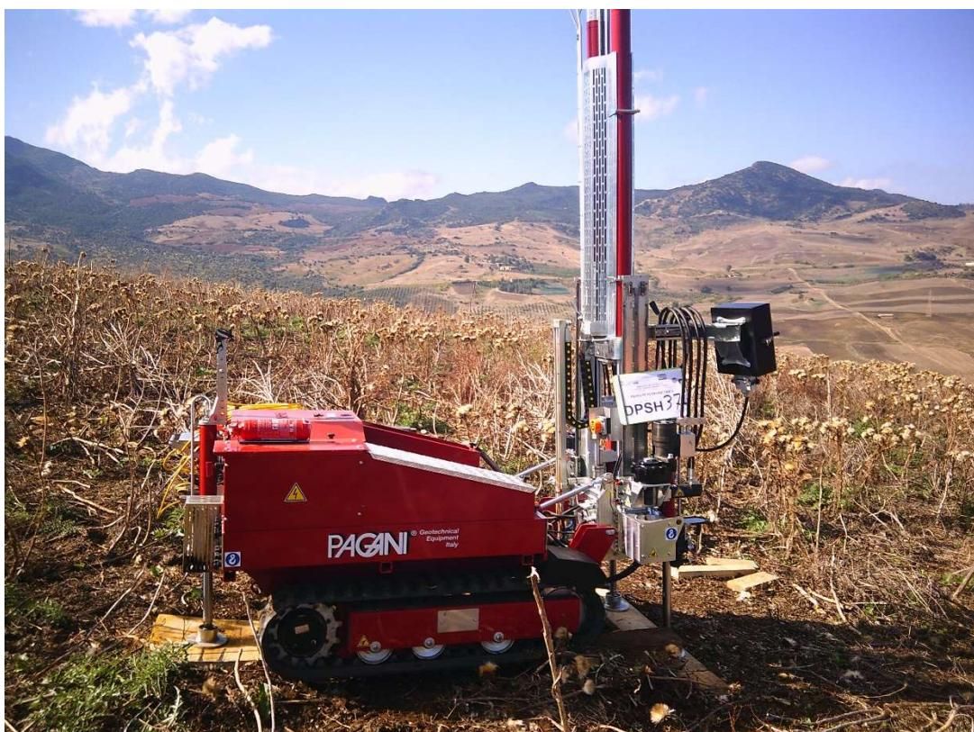
**PROVA PENETROMETRICA DINAMICA DPSH 37**
