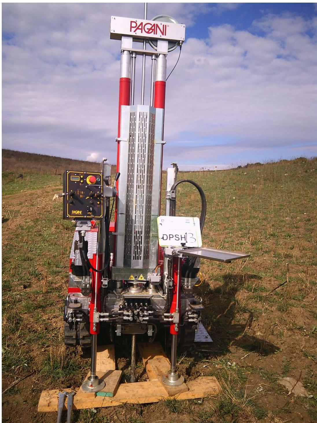
**PROVA PENETROMETRICA DINAMICA DPSH 13**
