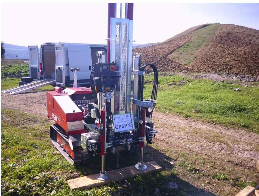
**PROVA PENETROMETRICA DINAMICA DPSH 32**
