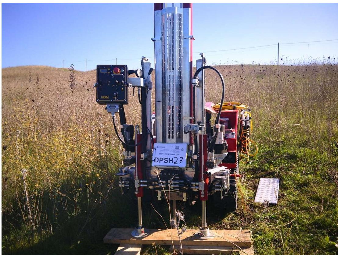
**PROVA PENETROMETRICA DINAMICA DPSH 27**
