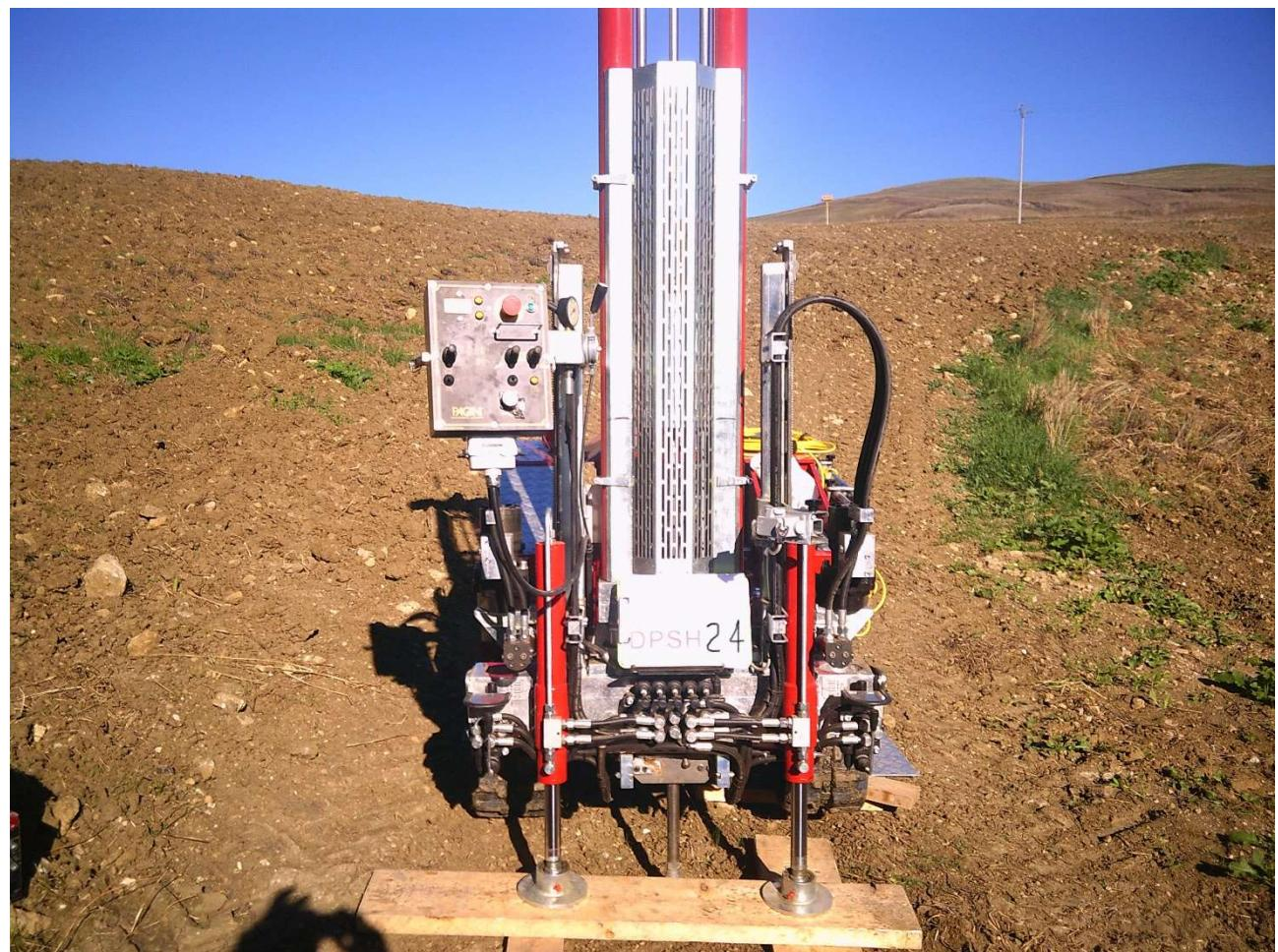
**PROVA PENETROMETRICA DINAMICA DPSH 24**
