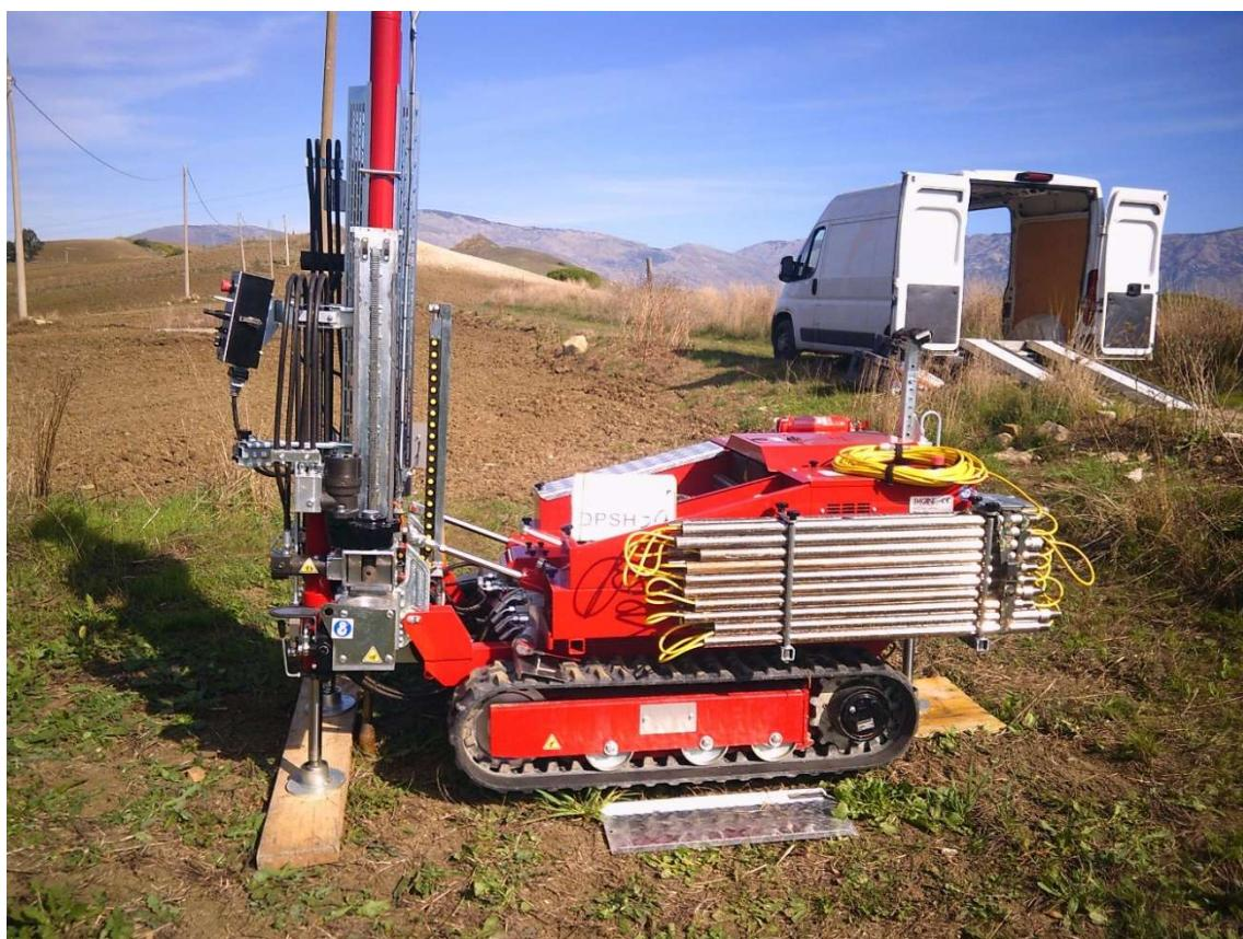
**PROVA PENETROMETRICA DINAMICA DPSH 30**
