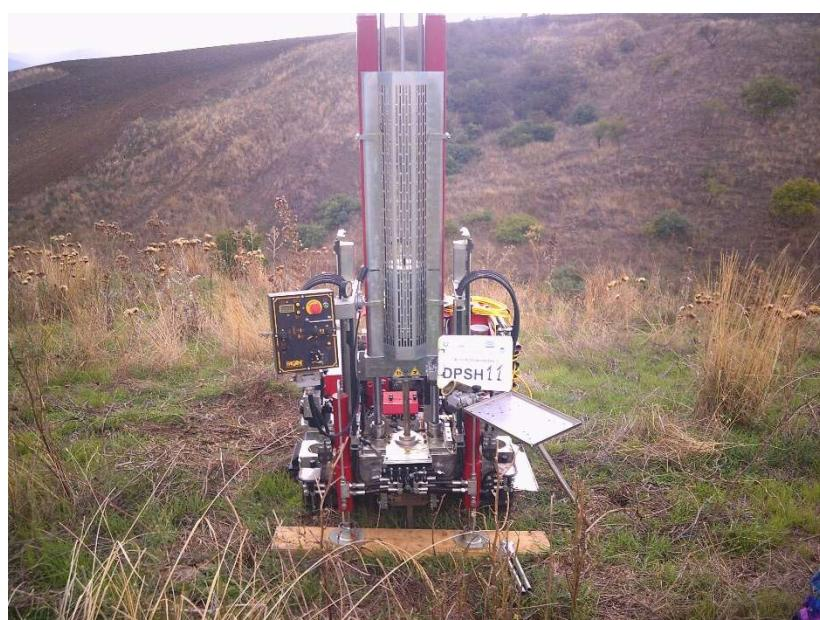
**PROVA PENETROMETRICA DINAMICA DPSH 11**
