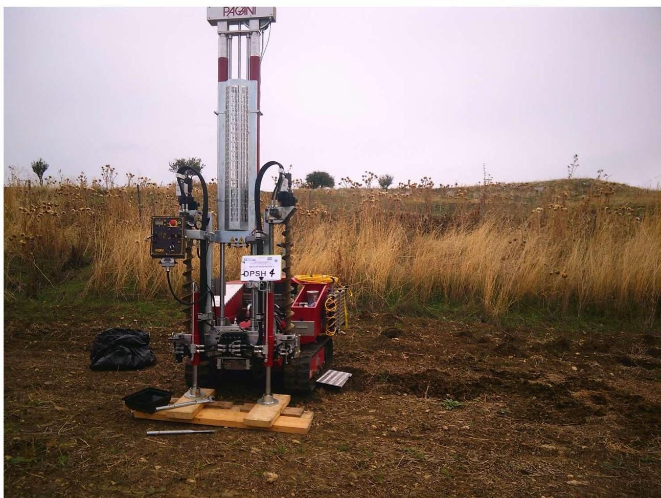
**PROVA PENETROMETRICA DINAMICA DPSH 4**
