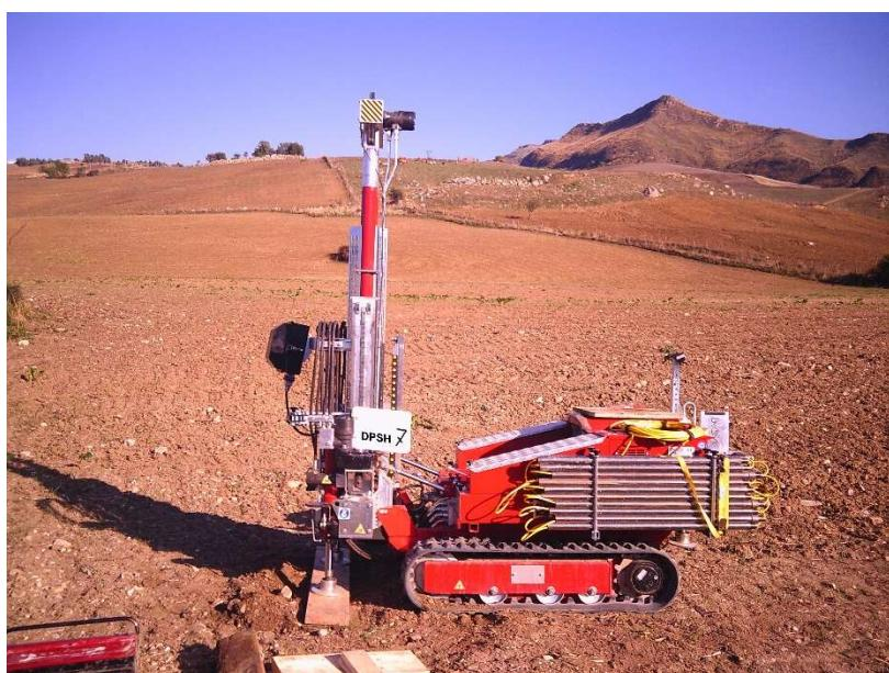
**PROVA PENETROMETRICA DINAMICA DPSH 7**
