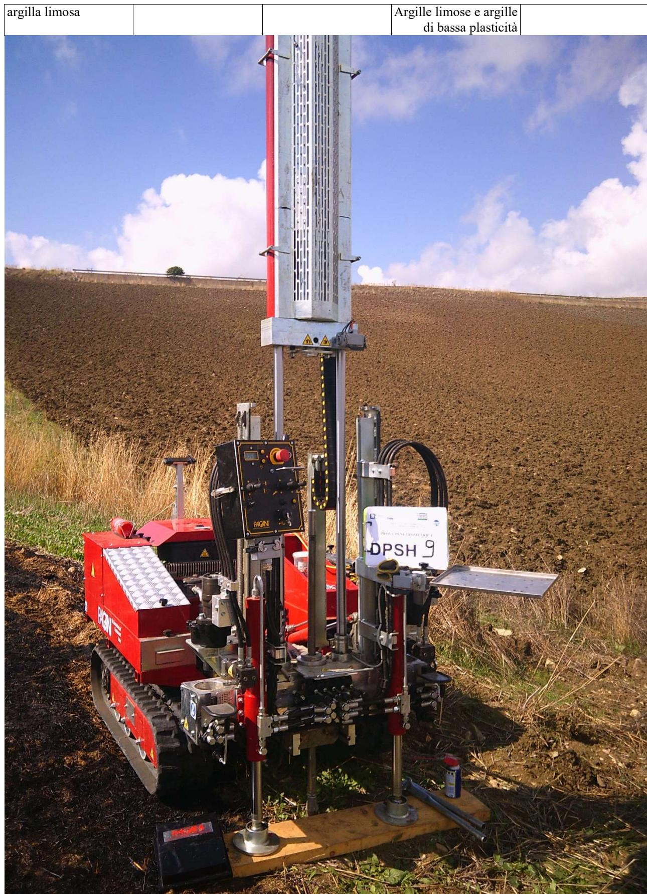
**PROVA PENETROMETRICA DINAMICA DPSH 9**
