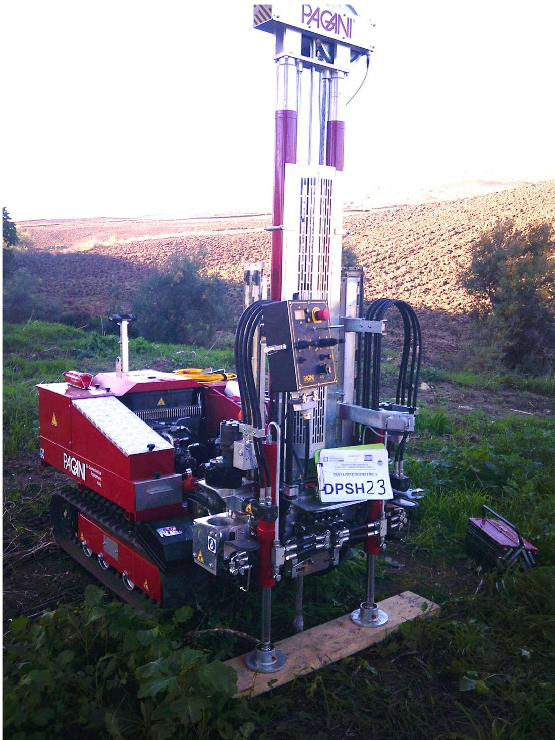
**PROVA PENETROMETRICA DINAMICA DPSH 23**
