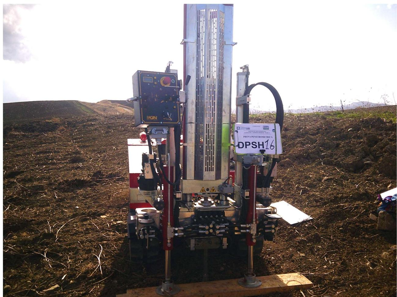
**PROVA PENETROMETRICA DINAMICA DPSH 16**
