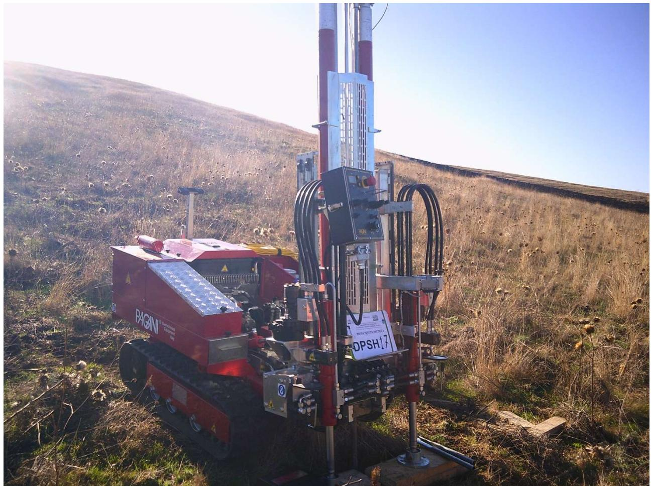
**PROVA PENETROMETRICA DINAMICA DPSH 17**
