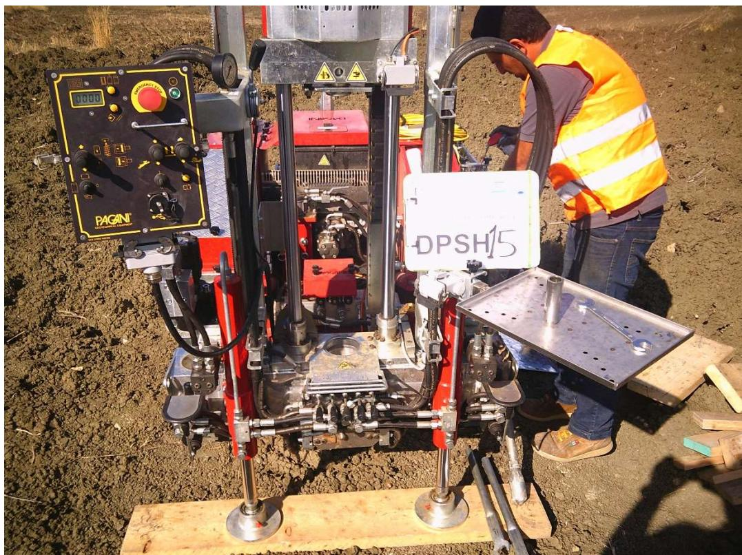
**PROVA PENETROMETRICA DINAMICA DPSH 15**
