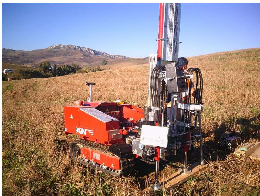
**PROVA PENETROMETRICA DINAMICA DPSH 26**
