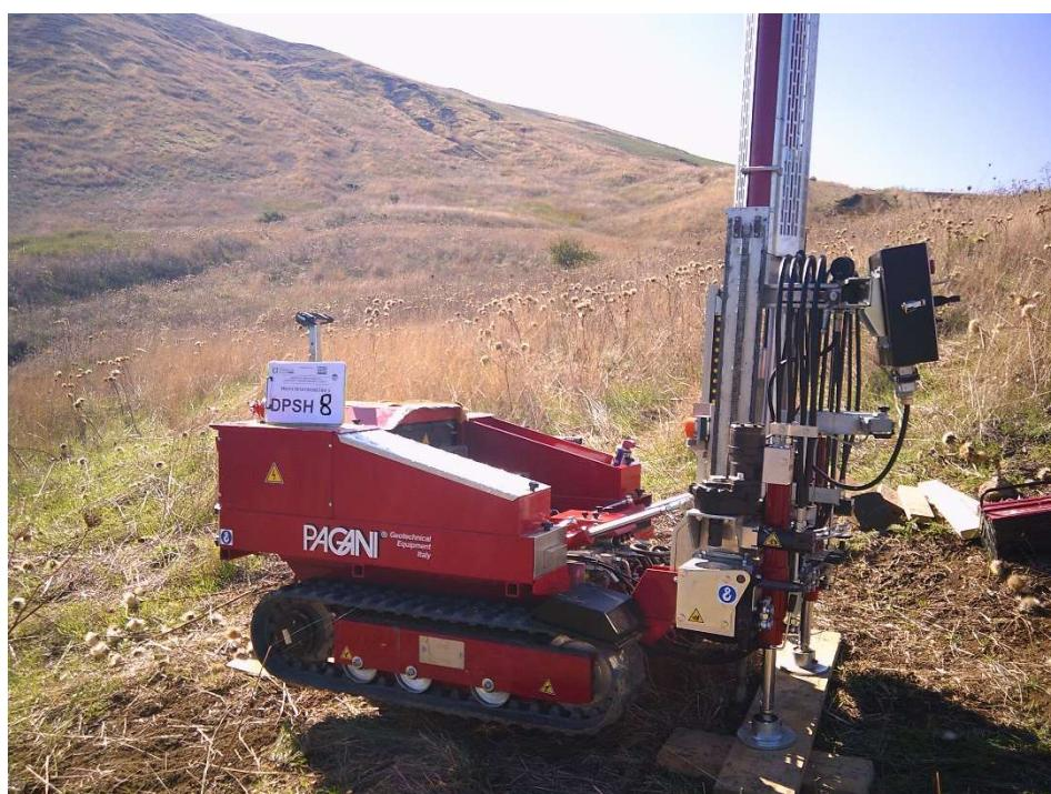
**PROVA PENETROMETRICA DINAMICA DPSH 8**
