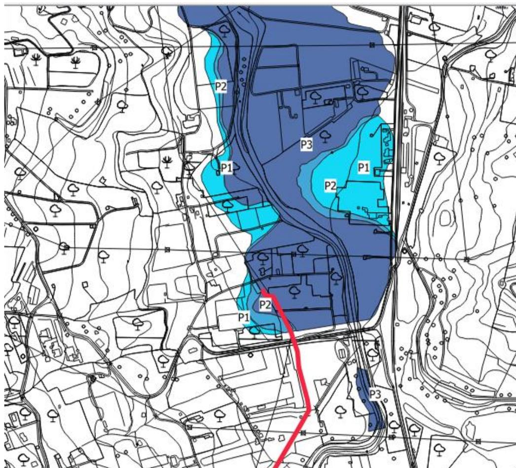
**Fig. 1-1 - Tracciato del metanodotto di progetto e interferenza con aree di pericolosità idraulica PAI**
