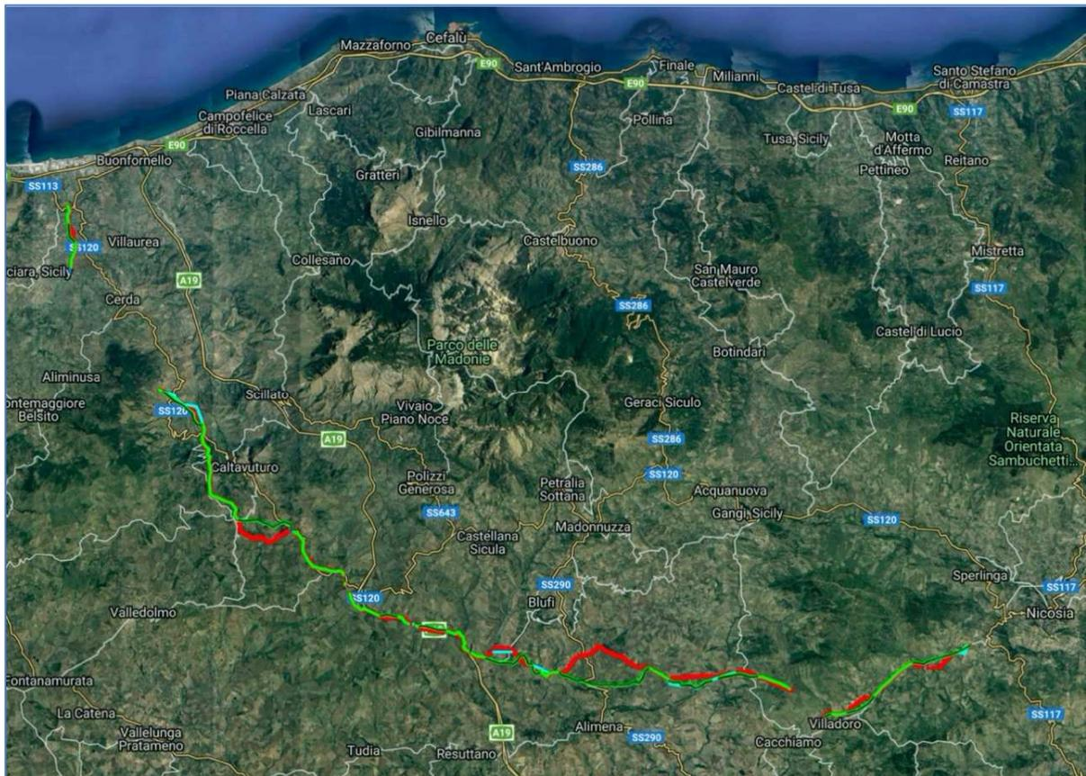
Fig. 1.1 – Foto satellitare con il posizionamento del metanodotto in progetto (in rosso) e di quello in dismissione (in verde) (fonte Google Earth).
