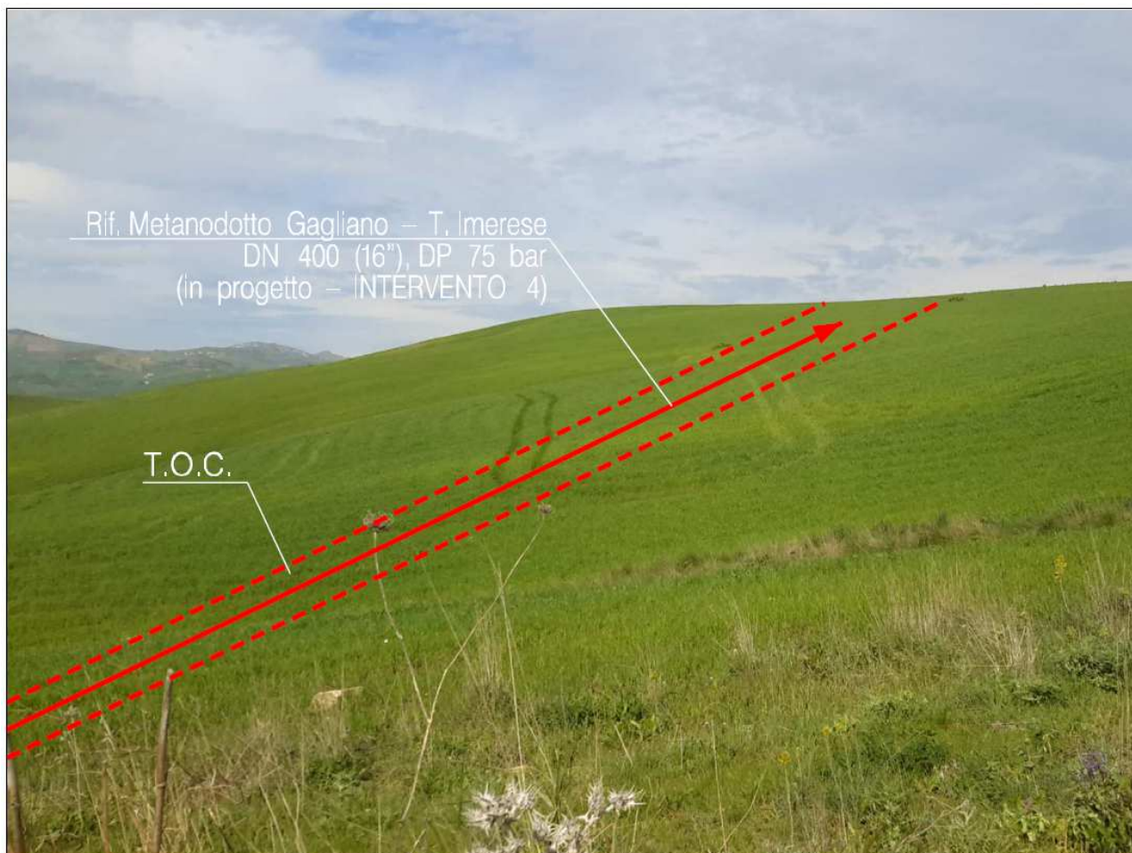
Figura 12 - TOC Casa Marabuto
