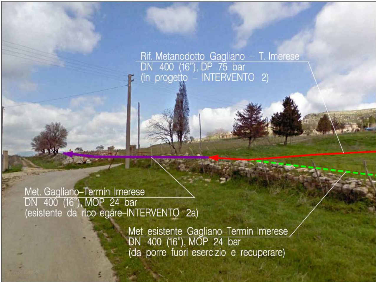
Figura 9 - Ricollegamento con tratto da mantenere, zona “Borgo Milletari”
