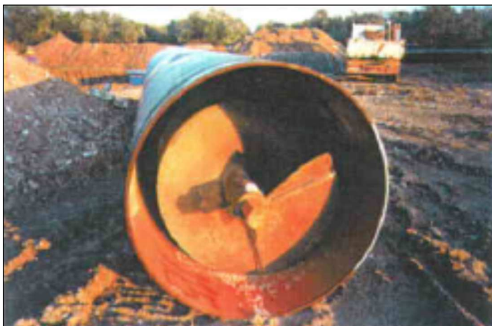
Fig. 1-38: Coclea per trivella spingitubo.
