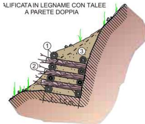
Fig. 1-49: Muro cellulare in legname a parete doppia.
