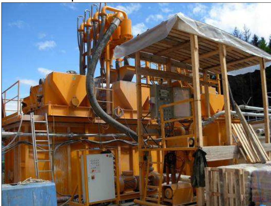
Fig. 1-43: Sistema di disidratazione.
