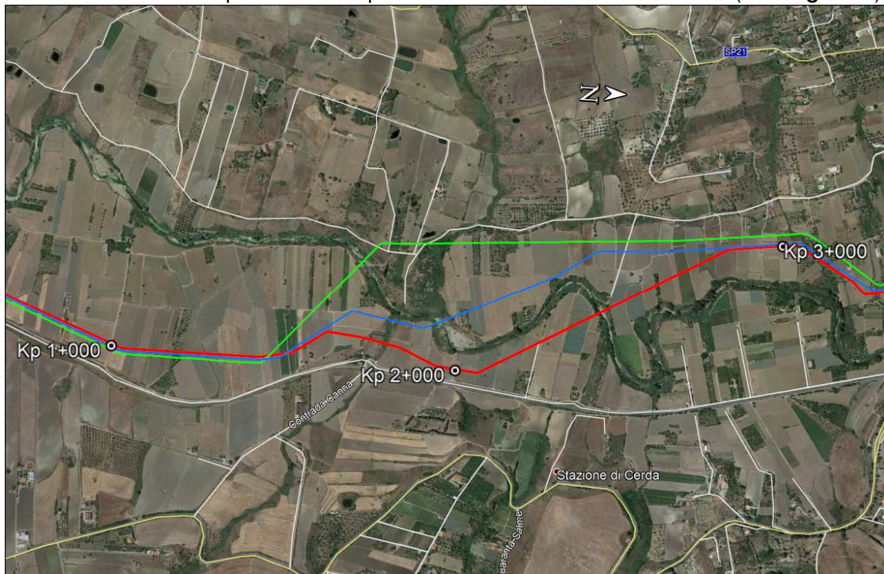
Fig. 1-18: Comuni di Termini Imerese (PA) e Sciara (PA), Loc. "Stazione di Cerda" – Inquadramento territoriale dei tracciati in progetto (rosso), rimozione (verde) e altri metanodotti esistenti (blu).
