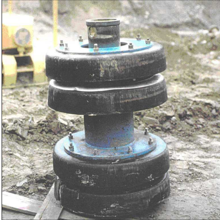
Fig. 1-64: Pig convenzionale impiegato nelle operazioni di collaudo idraulico e di pulizia della condotta.
