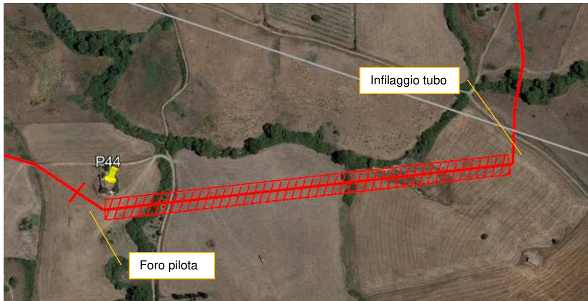
Figura 5 – Esempio di cantiere T.O.C.
