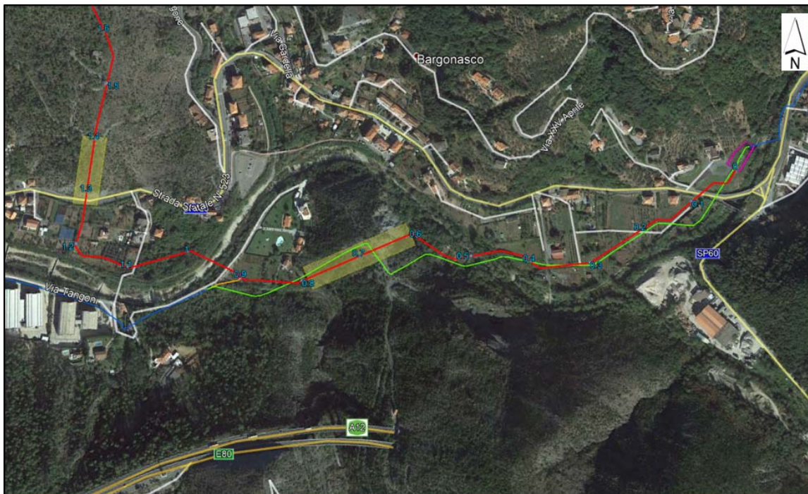
Fig. 3.5/A: metanodotto in dismissione (in verde) in prossimità della nuova linea in progetto (in rosso)
