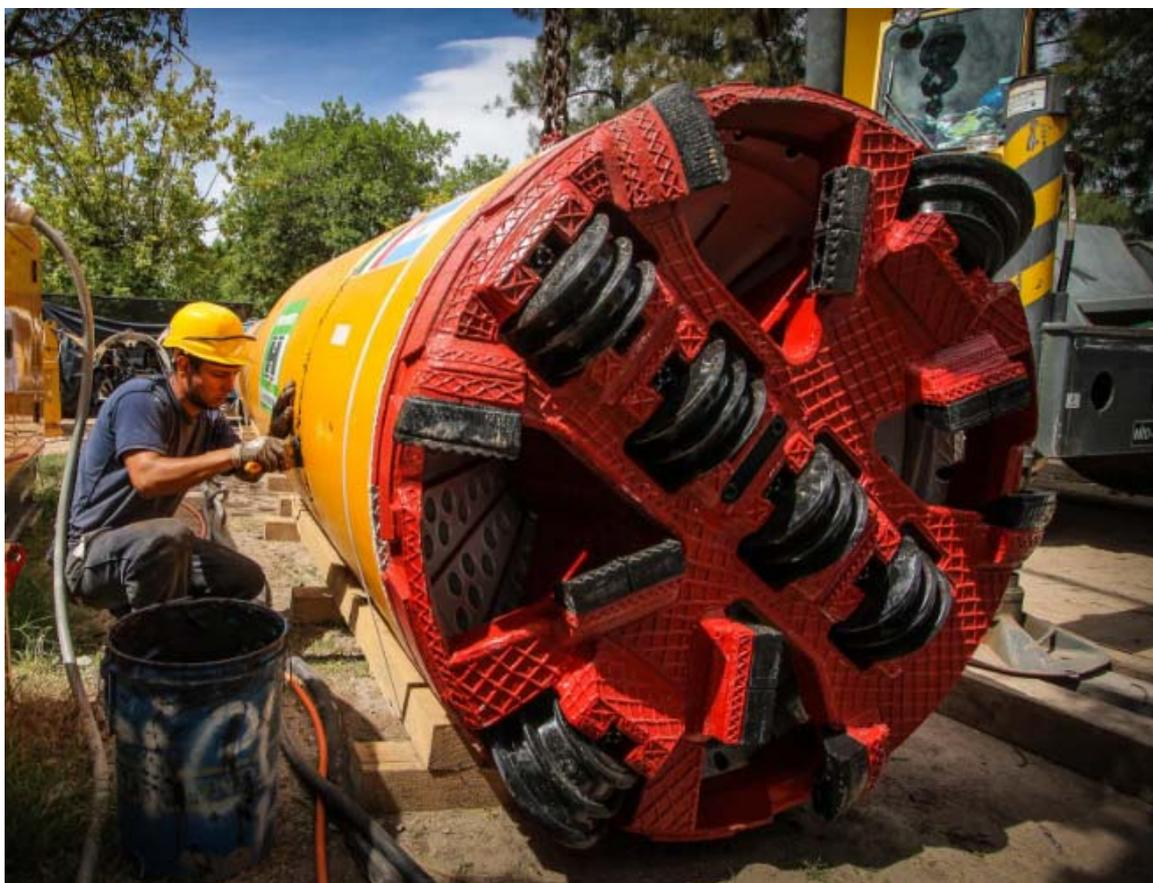
**Fig. 4/A:** Esempio di testa fresante di microtunnel
