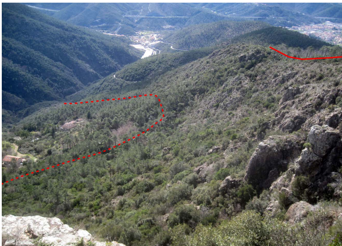
Fig. 1/C: Campo Albaro. Tracciato di progetto (linea rossa continua) lungo il crinale a monte dell'area Pg4. LEGENDA: linea rossa tratteggiata (limite dell'area di frana Pg4)
