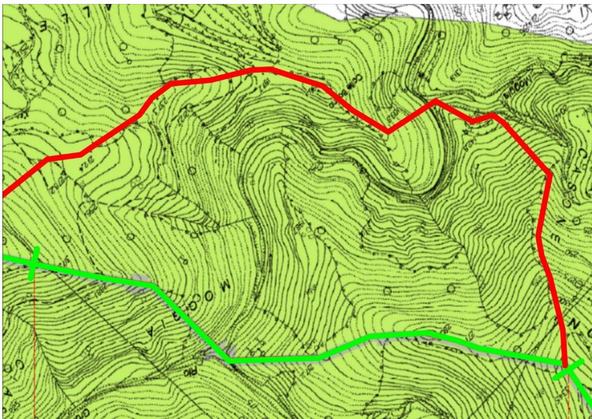
**Fig. 1.1/B:** Stralcio modificato dalla Carta idrogeologica a scala 1:10.000 (Dis. LB-D-83217) nel tratto compreso tra kp7.0 e kp8.0. **LEGENDA:** tracciato della variante sul Torrente Gromolo (linea rossa – LA-E-83023); tracciato di progetto presentato nel SIA (linea verde); Complesso ofiolitico (cof)
