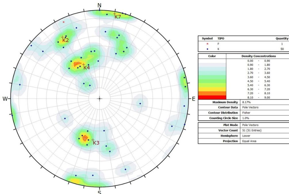
**Fig. 3.5/C** Proiezione equiareale sulla semisfera inferiore delle discontinuità di frattura rilevate nelle ardesie delle stazioni CAS 1 e CAS2 (il simbolo di colore blu indica le fratture, il simbolo rosso le faglie)
