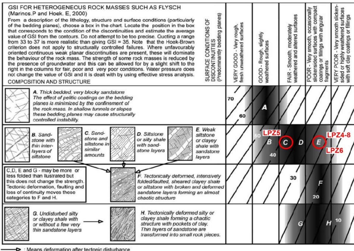
**Fig. 2.5/L Classificazione GSI dell'ammasso roccioso di ardesie**
