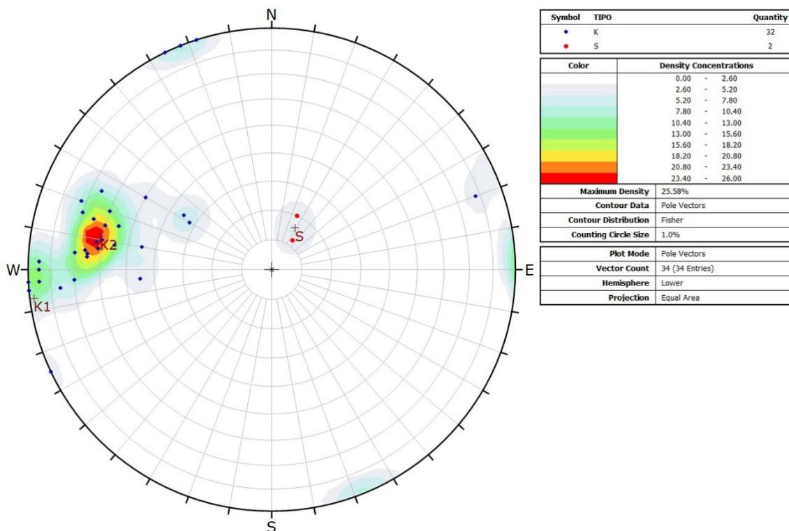
**Fig. 5.5/F** Proiezione stereografica equiareale dei poli delle discontinuità rilevate nella stazione MB4 (simbolo di colore blu per le discontinuità di frattura, di colore rosso per la stratificazione)
