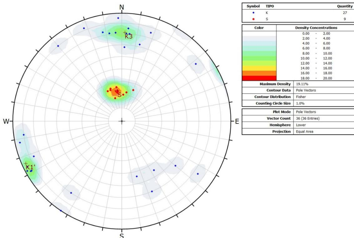
**Fig. 5.5/D** Proiezione stereografica equiareale dei poli delle discontinuità rilevate nella stazione MB2 (simbolo di colore blu per le discontinuità di frattura, di colore rosso per la stratificazione)
