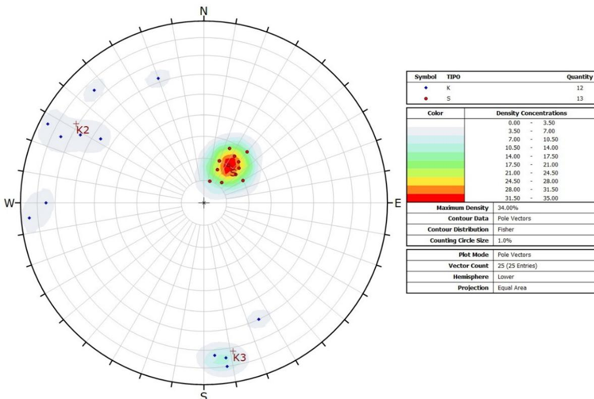
**Fig. 4.5/C Stazione COC1. Proiezione equiareale sulla semisfera inferiore delle discontinuità rilevate negli scisti manganeseiferi (il simbolo di colore blu indica le discontinuità di fratture, il simbolo rosso la scistosità)**
