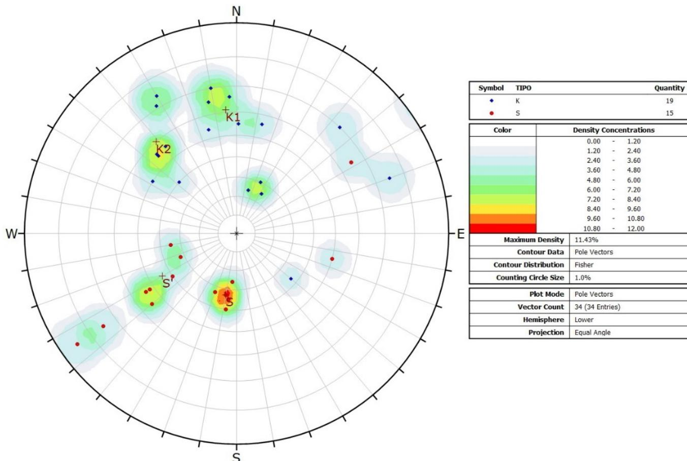
**Fig. 1.5/A** Proiezione equiareale sulla semisfera inferiore delle discontinuità rilevate in ardesie della stazione SMR1 (il simbolo di colore blu indica le discontinuità di frattura, il circolo rosso la stratificazione).
