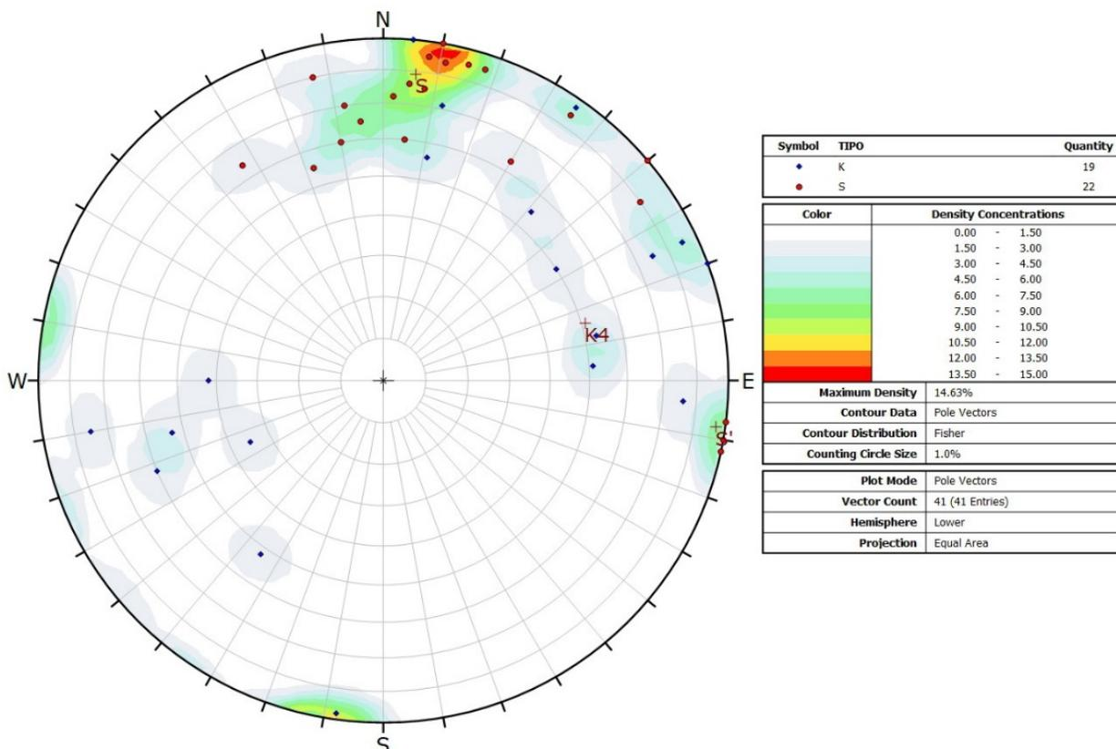
**Fig. 1.5/D** Proiezione equiareale sulla semisfera inferiore delle discontinuità rilevate nelle arenarie del Monte Gottero della stazione SMR5 (il circolo rosso indica la stratificazione-scistosità, il simbolo blu le fratture)
