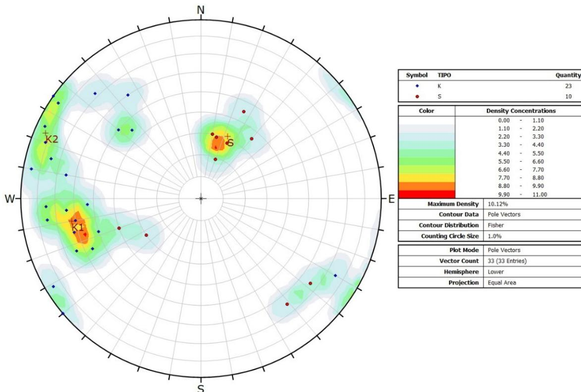
**Fig. 4.5/D Stazione COC2. Proiezione equiareale sulla semisfera inferiore delle discontinuità rilevate negli scisti manganeseiferi (il simbolo di colore blu indica le discontinuità di fratture, il simbolo rosso la scistosità)**
