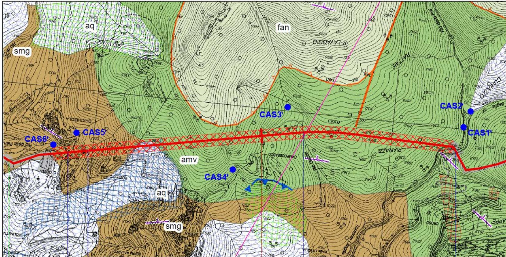
**Fig. 3.5/A** Stralcio modificato dalla Carta geologico-geomorfologica a scala 1:10.000 (Dis. LB-D-83209). **LEGENDA:** Ardesie del Monte Verzi, (amv), Scisti Manganesiferi (smg), depositi di frana (aq), depositi di versante (a1), depositi alluvionali recenti e terrazzati (b1), depositi alluvionali degli alvei attuali (b), movimenti franosi da Piano di Bacino (quadrettato verde), stazioni del rilievo geomeccanico (simbolo circolare blu ed etichetta blu)
