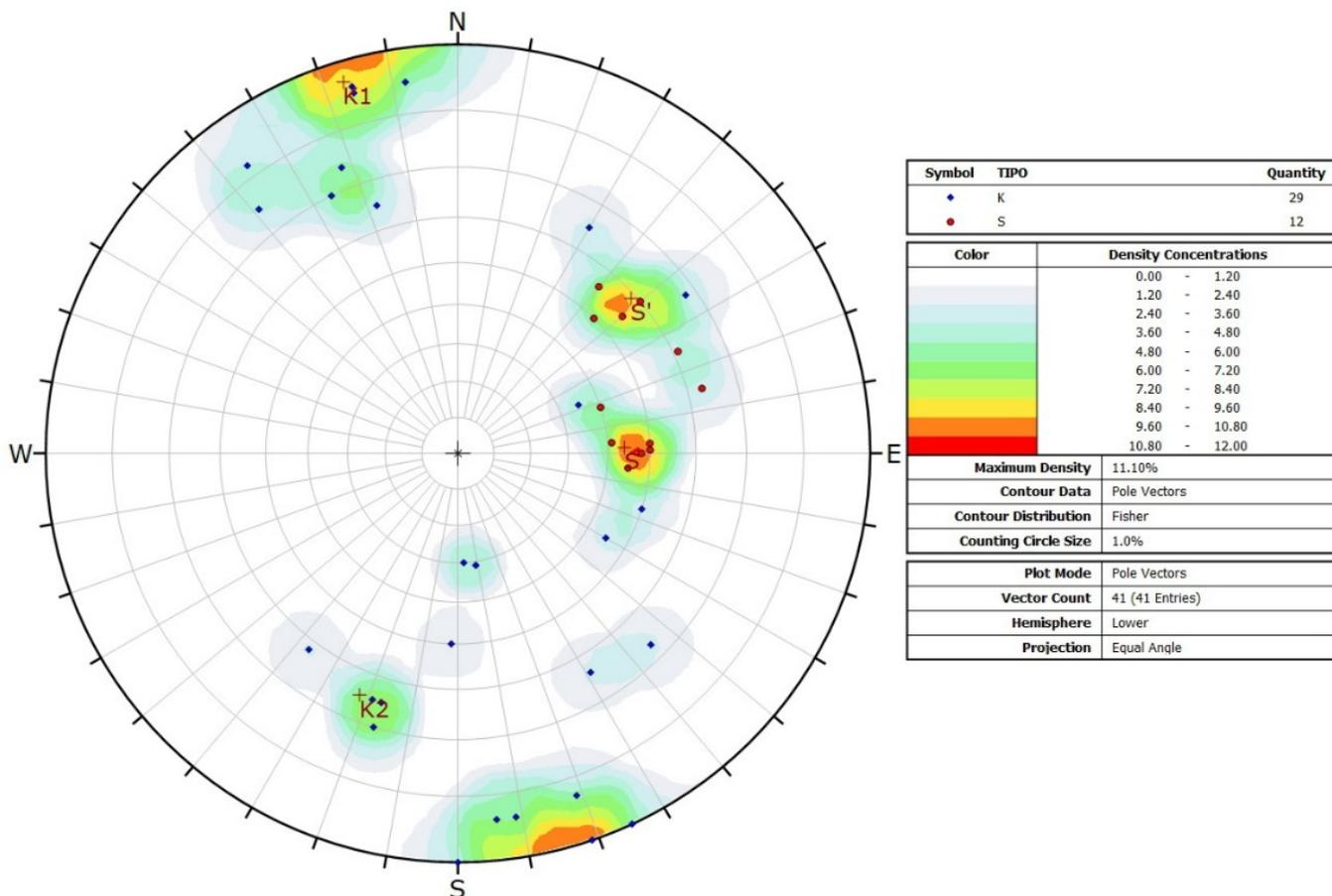
**Fig. 1.5/B** Proiezione equiareale sulla semisfera inferiore delle discontinuità rilevate nelle arenarie del Monte Gottero delle stazioni SMR2 e SMR3 (il simbolo di colore blu indica le discontinuità di frattura, il cerchio rosso la stratificazione-scistosità)
