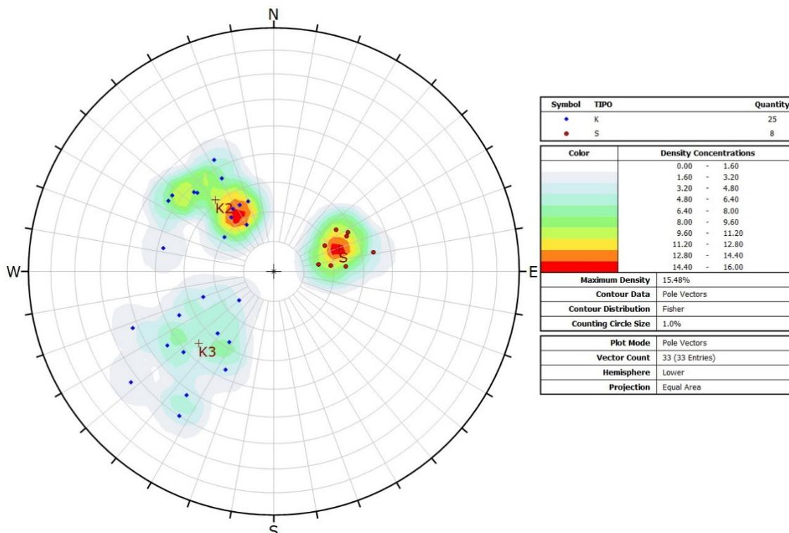
**Fig. 2.5/E** Proiezione equiareale sulla semisfera inferiore delle discontinuità rilevate nelle ardesie della stazione LPZ6 (il simbolo di colore blu indica le discontinuità di frattura, il circolo rosso la stratificazione-scistosità)
