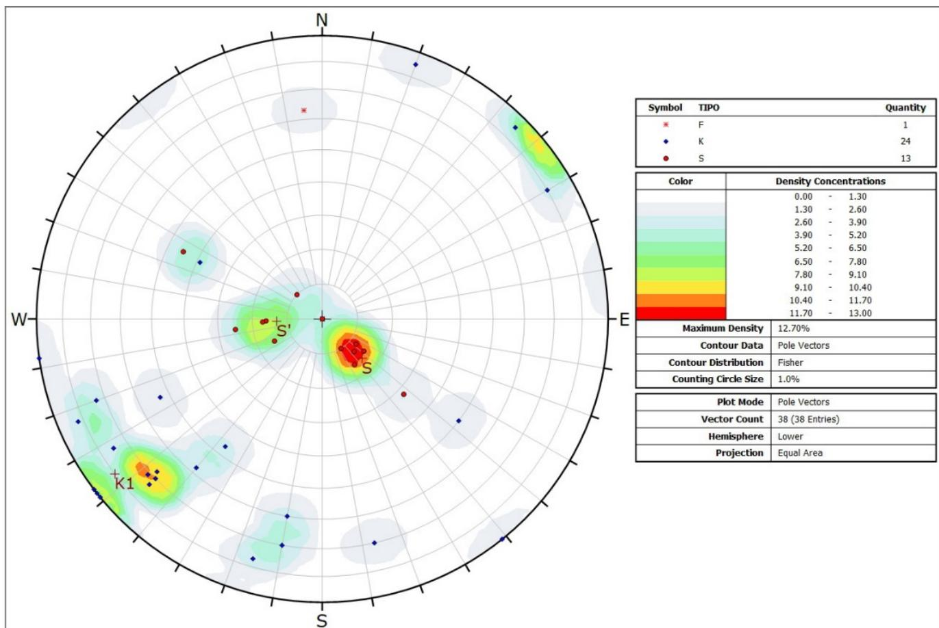
**Fig. 2.5/C** Proiezione equiareale sulla semisfera inferiore delle discontinuità rilevate in ardesie delle stazioni LPZ4-LPZ8 (il simbolo di colore blu indica le discontinuità di frattura, il circolo rosso la stratificazione-schistosità)
