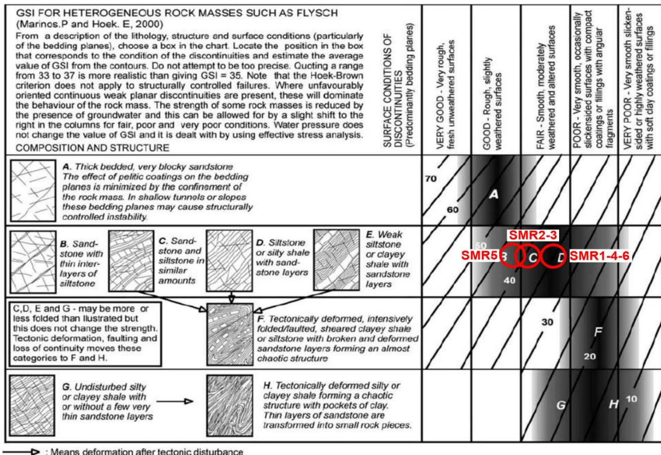
**Fig. 1.5/N Classificazione GSI degli ammassi rocciosi di ardesie ed arenarie**
