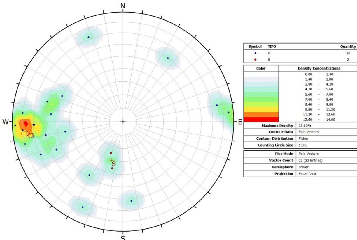
**Fig. 1.5/E** Proiezione equiareale sulla semisfera inferiore delle discontinuità rilevate nelle ardesie della stazione SMR6 (il circolo rosso indica la stratificazione-scistosità)
