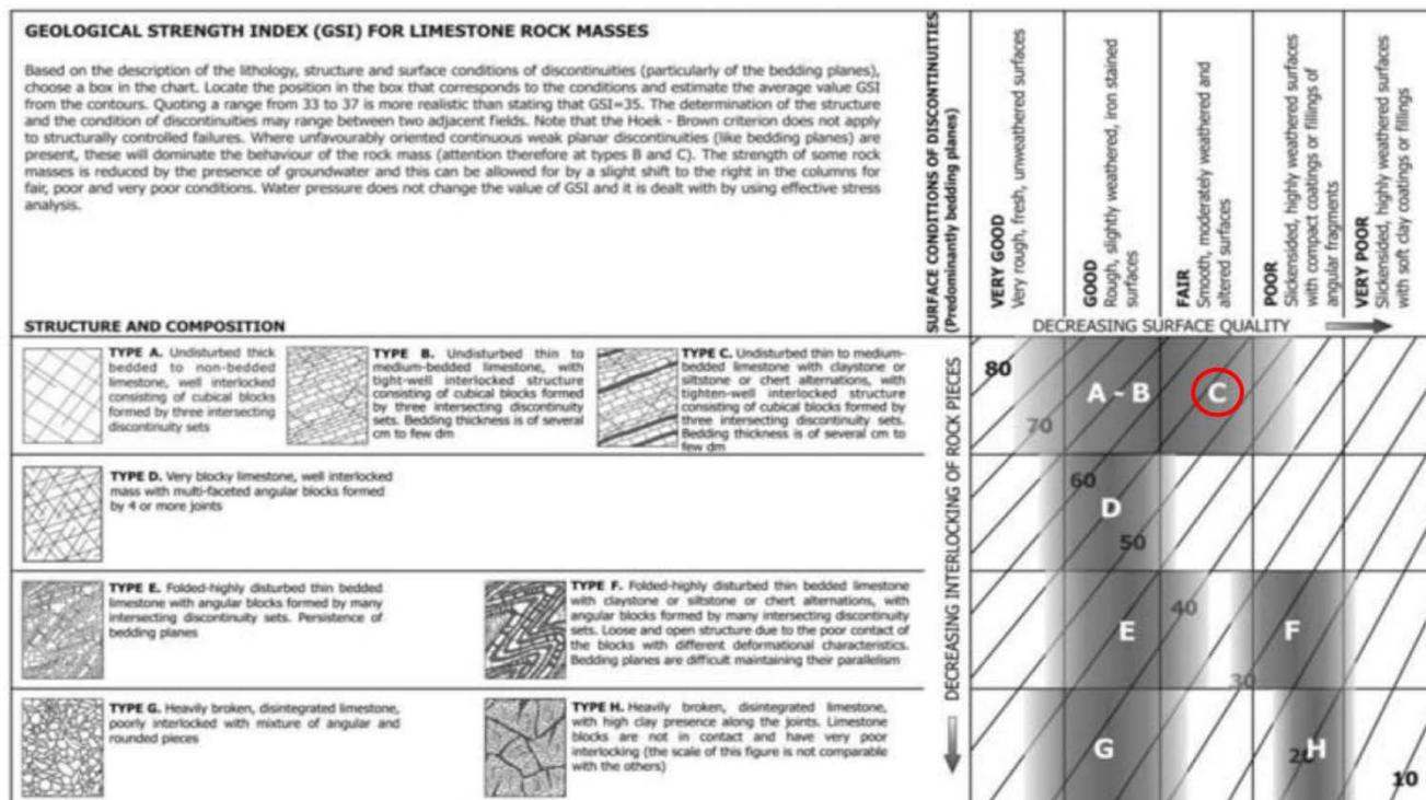
**Fig. 5.5/O** Classificazione GSI degli ammassi rocciosi di calcari marnosi
