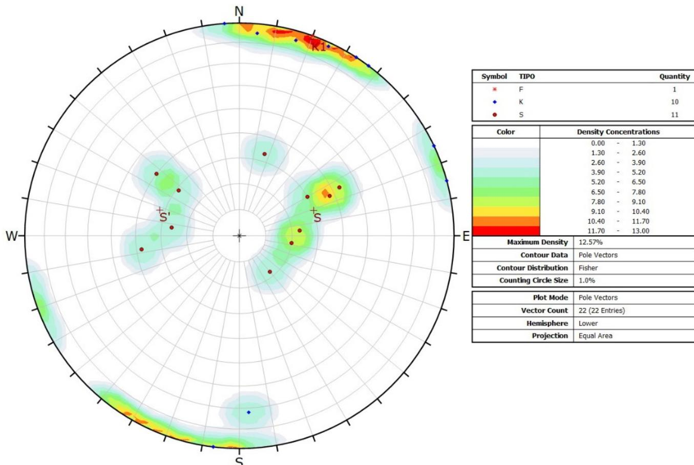
**Fig. 2.5/D** Proiezione equiareale sulla semisfera inferiore delle discontinuità rilevate in ardesie della stazione LPZ5 (il simbolo di colore blu indica le discontinuità di frattura, il cerchio rosso la stratificazione-schistosità, l'asterisco rosso le faglie)
