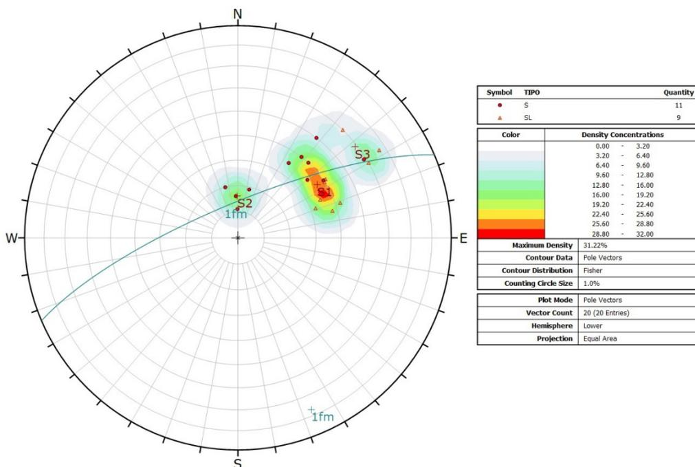
**Fig. 3.5/D** Proiezione equiareale sulla semisfera inferiore delle discontinuità rilevate ardesie delle stazioni CAS 1 e CAS2 (il simbolo triangolare di colore rosa indica la stratificazione, il simbolo circolare rosso la scistosità)
