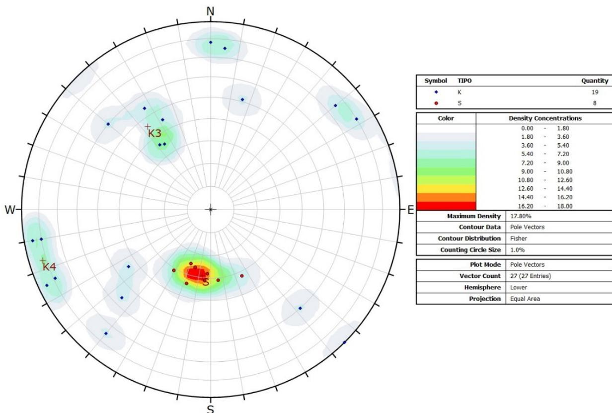
**Fig. 1.5/C** Proiezione equiareale sulla semisfera inferiore delle discontinuità rilevate nelle ardesie della stazione SMR4 (il simbolo di colore blu indica le discontinuità di frattura, il circolo rosso indica la stratificazione-scistosità)
