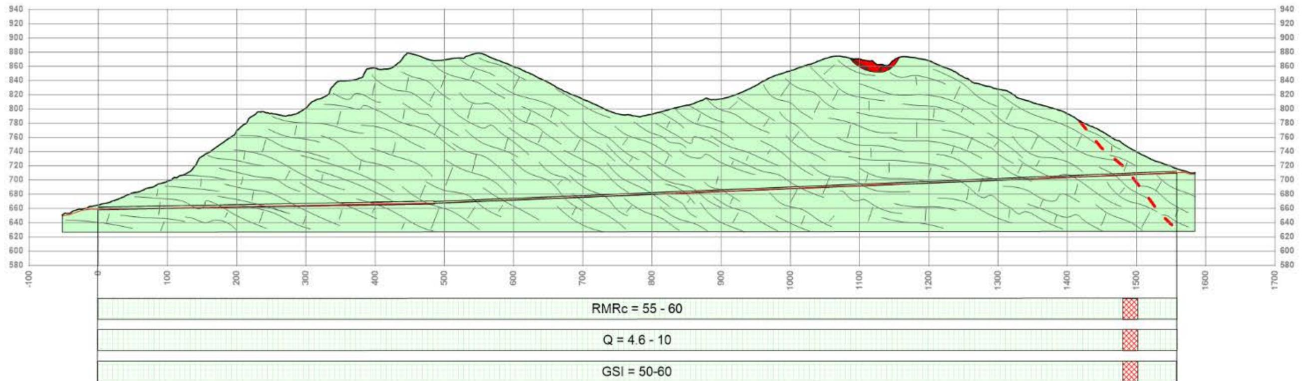
**Fig. 5.5/B** Sezione geologico –geomeccanica lungo il tracciato del microtunnel Monte Bado (senso gas). **LEGENDA:** Formazione del Monte Antola (colore verde chiaro), accumulo di frana quiescente Pg3a (colore rosso), tracciato della galleria e del microtunnel (linee di colore nero), tracciato del metanodotto (linea di colore rosso). Nella fincatura sono riportati i valori delle classificazioni geomeccaniche; in quadrettato rosso la possibile zona di faglia
