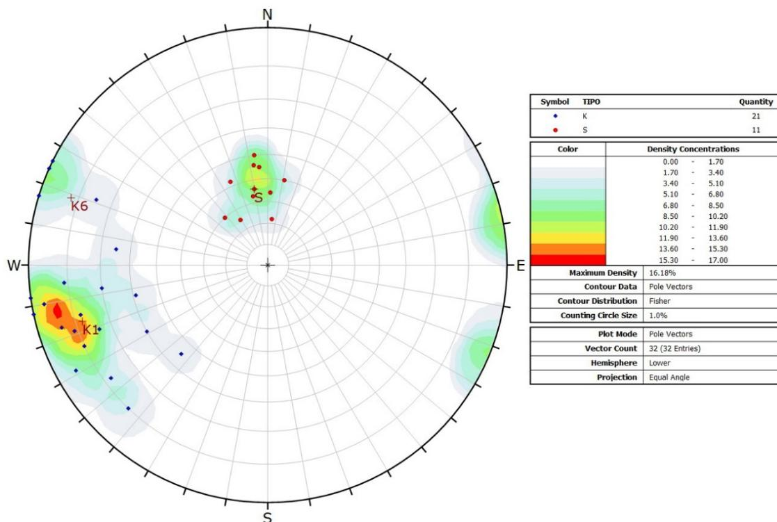
**Fig. 3.5/F** Proiezione equiareale sulla semisfera inferiore delle discontinuità rilevate negli scisti manganiferi delle stazioni CAS5 e CAS6 (il simbolo di colore blu indica le discontinuità di fratture, il simbolo rosso la scistosità)
