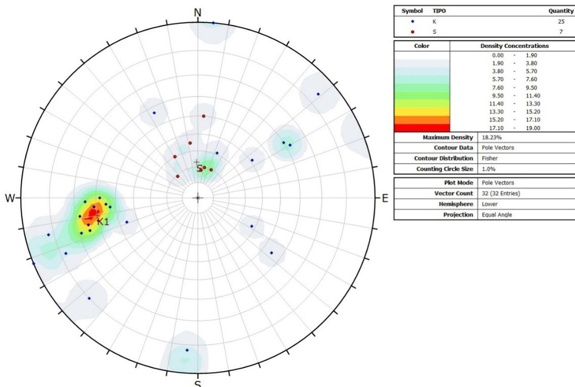
**Fig. 5.5/G** Proiezione stereografica equiareale dei poli delle discontinuità rilevate nella stazione MB5 (simbolo di colore blu per le discontinuità di frattura, di colore rosso per la stratificazione)
