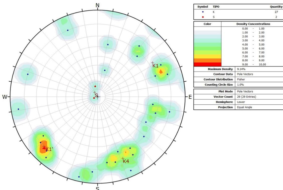
**Fig. 5.5/C** Proiezione stereografica equiareale dei poli delle discontinuità rilevate nella stazione MB1 (simbolo di colore blu per le discontinuità di frattura, di colore rosso per la stratificazione).
