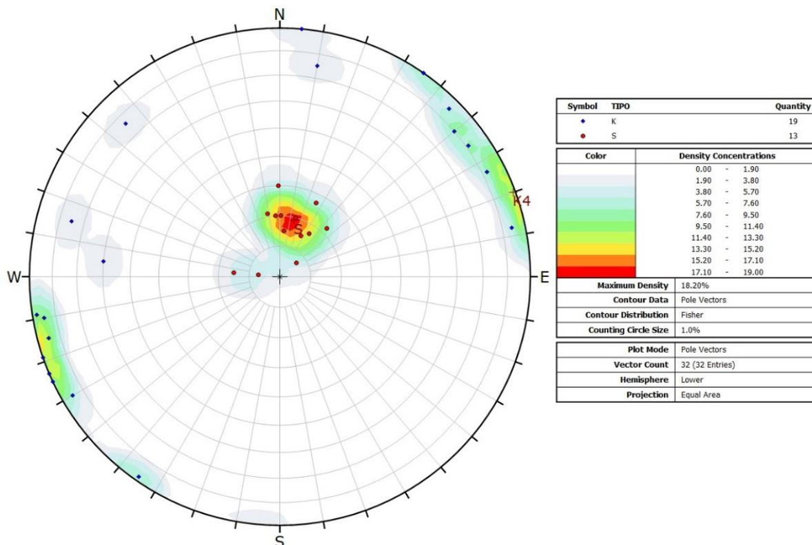
**Fig. 5.5/E** Proiezione stereografica equiareale dei poli delle discontinuità rilevate nella stazione MB3 (simbolo di colore blu per le discontinuità di frattura, di colore rosso per la stratificazione)
