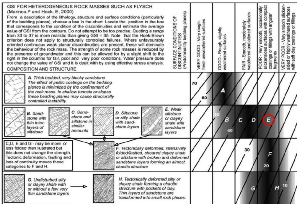
Fig. 4.5/O Classificazione GSI degli ammassi rocciosi di scisti manganeseiferi
