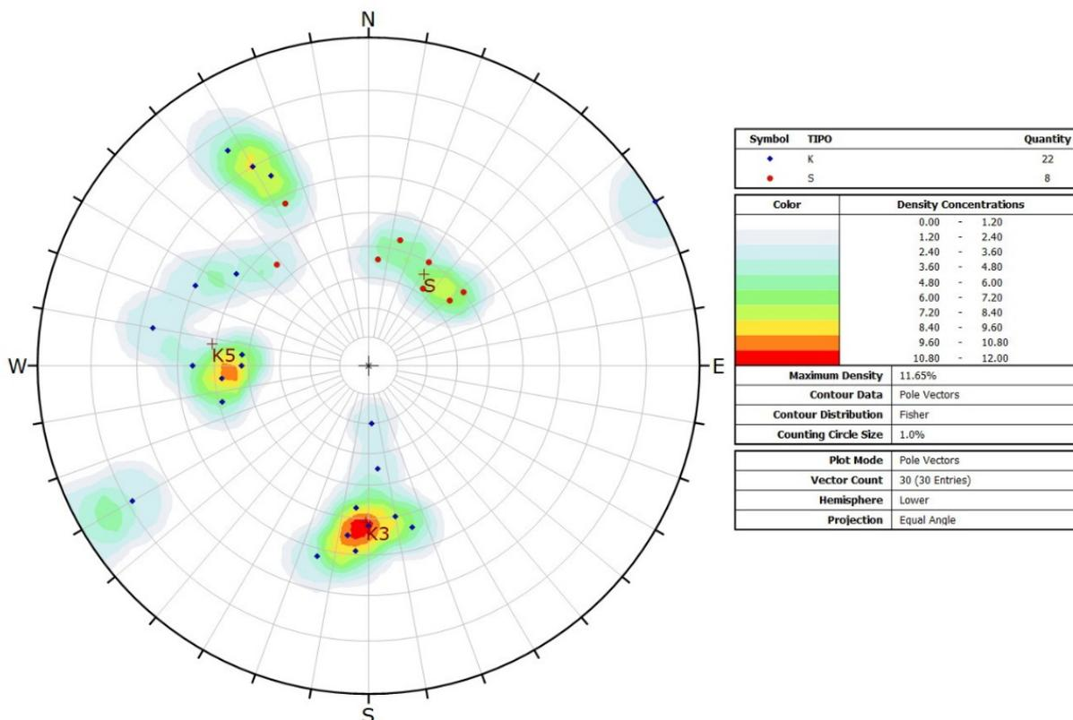
**Fig. 3.5/E** Proiezione equiareale sulla semisfera inferiore delle discontinuità rilevate nelle ardesie delle stazioni CAS 3 e CAS4 (il simbolo di colore blu indica le discontinuità di fratture, il simbolo rosso la scistosità)
