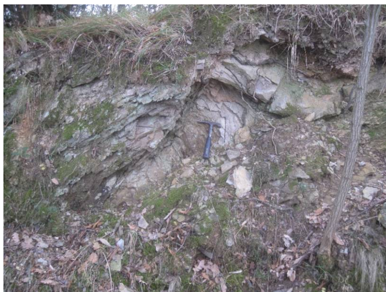
Foto 26: Area Pg3b (km 17,41-17,70). Affioramento di arenarie e argilliti lungo la scarpata stradale
