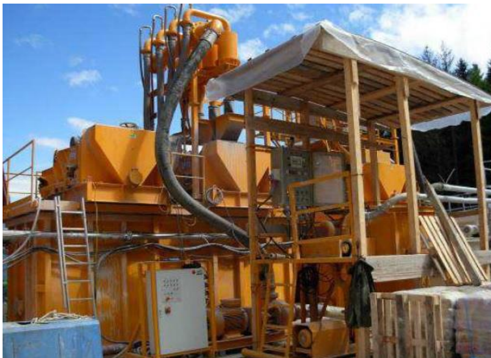
Figura 2-22 – Sistema di disidratazione
