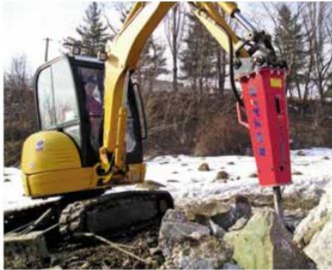
Figura 3-1: esempio di martello demolitore idraulico
