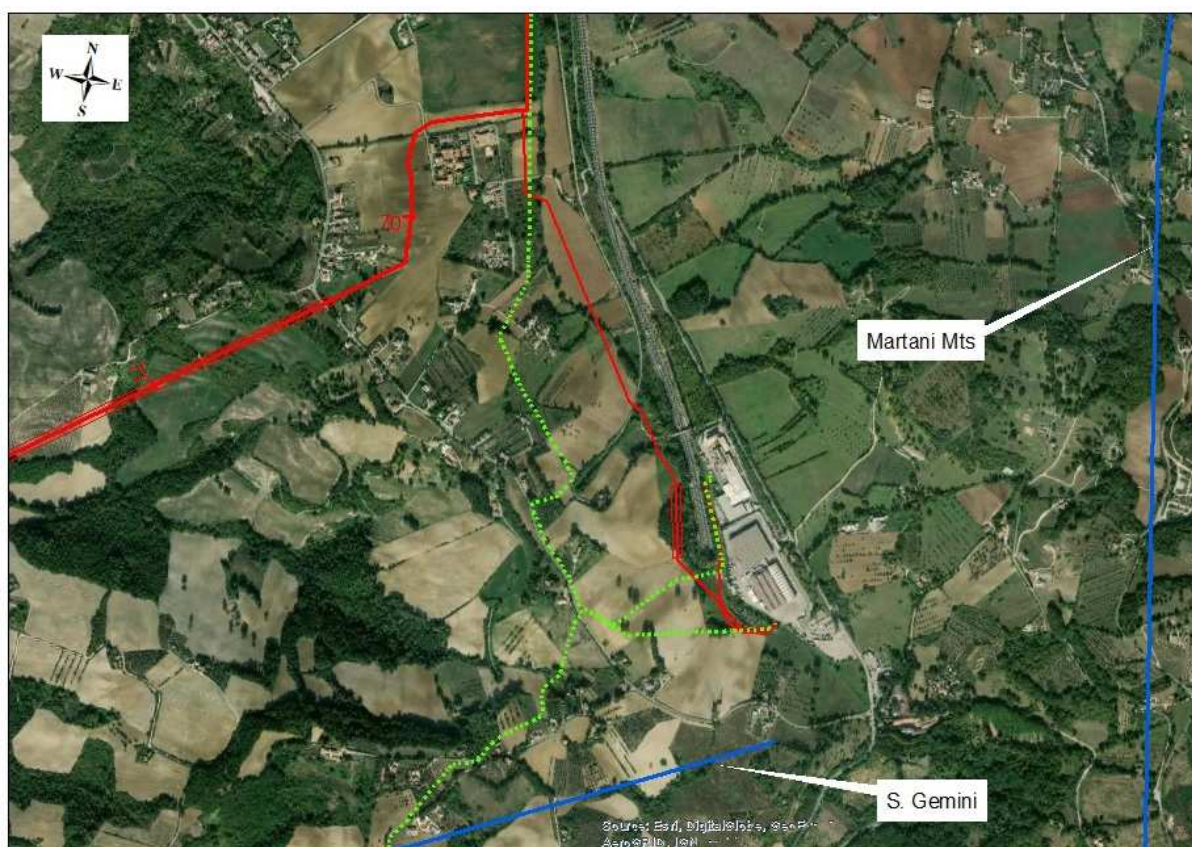
Fig.3.2.8- Vicinanza faglia San Gemini (63200), con metanodotto in progetto. Linea rossa con tacche chilometriche: tracciato in progetto, linea verde tratteggiata: tracciato in dismissione, linea blu: Faglia attiva e capace.
