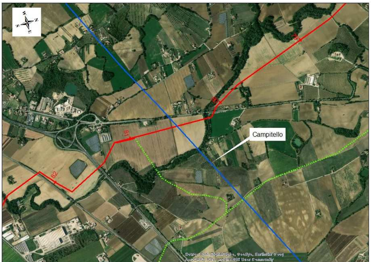
Fig.3.1.4 - Intersezione faglia Campitello col metanodotto (Km 80+530). Linea rossa con tacche chilometriche: tracciato in progetto, linea verde tratteggiata: tracciato in dismissione, linea blu: Faglia attiva e capace.
