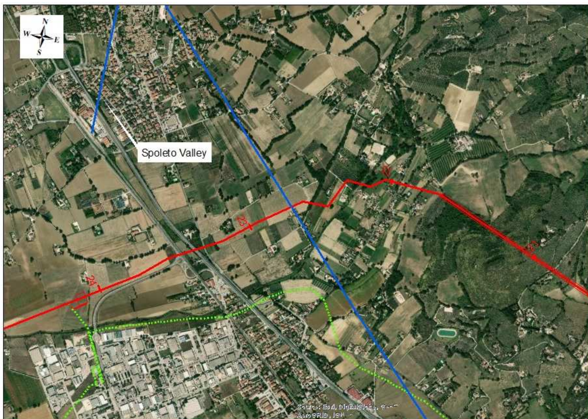
Fig.3.2.4- Vicinanza faglia Spoleto Valley (62402), con metanodotto in progetto. Linea rossa con tacche chilometriche: tracciato in progetto, linea verde tratteggiata: tracciato in dismissione, linea blu: Faglia attiva e capace.
