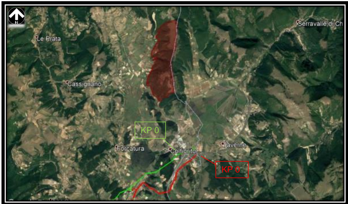
Figura 5-47 - ZSC IT5210031 "Col Falcone (Colfiorito)" e interazione con le opere in progetto "Rif. Met. Foligno (fraz. Colfiorito) - Gallese DN 650 (26") DP 75 bar" (rosso) e in rimozione "Met. Recanati - Foligno DN 600 (24") MOP 70 bar" (verde)
