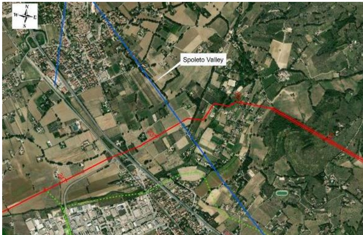
Figura 11-4 - Intersezione faglia Spoletto Valley (linea blu) al Km 22+720. Linea rossa con tacche chilometriche: tracciato in progetto, linea verde tratteggiata: tracciato in dismissione
