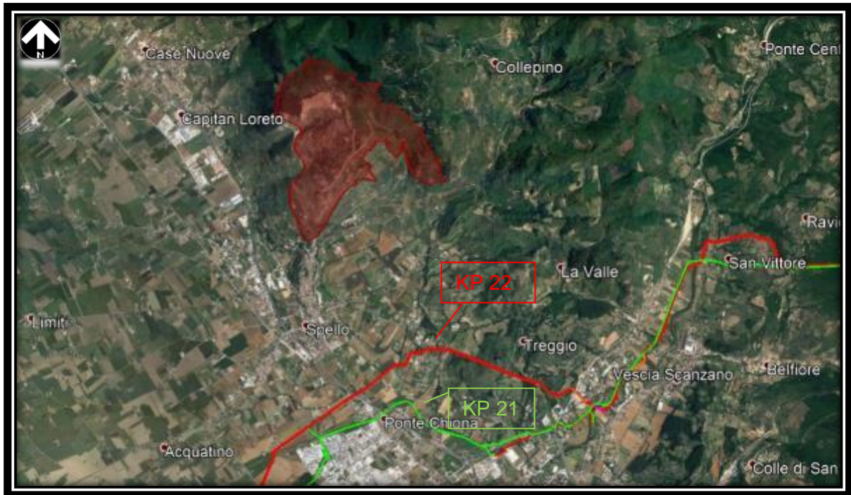
Figura 5-49 - ZSC IT5210035 "Poggio Caselle - Fosso Renaro" e interazione con le opere in progetto "Rif. Met. Foligno (fraz. Colfiorito) – Gallese DN 650 (26") DP 75 bar" (rosso) e in rimozione "Met. Recanati – Foligno DN 600 (24") MOP 70 bar" (verde)
