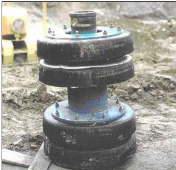
Figura 3-46 – Pig convenzionale impiegato in operazioni di collaudo idraulico e pulizia della condotta
