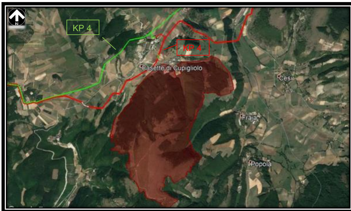
Figura 5-50 - ZSC IT5210037 "Selva di Cupigliolo" e interazione con le opere in progetto "Rif. Met. Foligno (fraz. Colfiorito) - Gallese DN 650 (26") DP 75 bar" (rosso) e in rimozione "Met. Recanati - Foligno DN 600 (24") MOP 70 bar" (verde)
