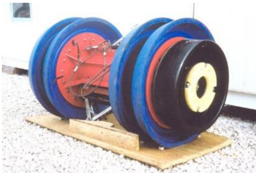
Figura 3-47 – Pig strumentale per il controllo della geometria e dello spessore della condotta
