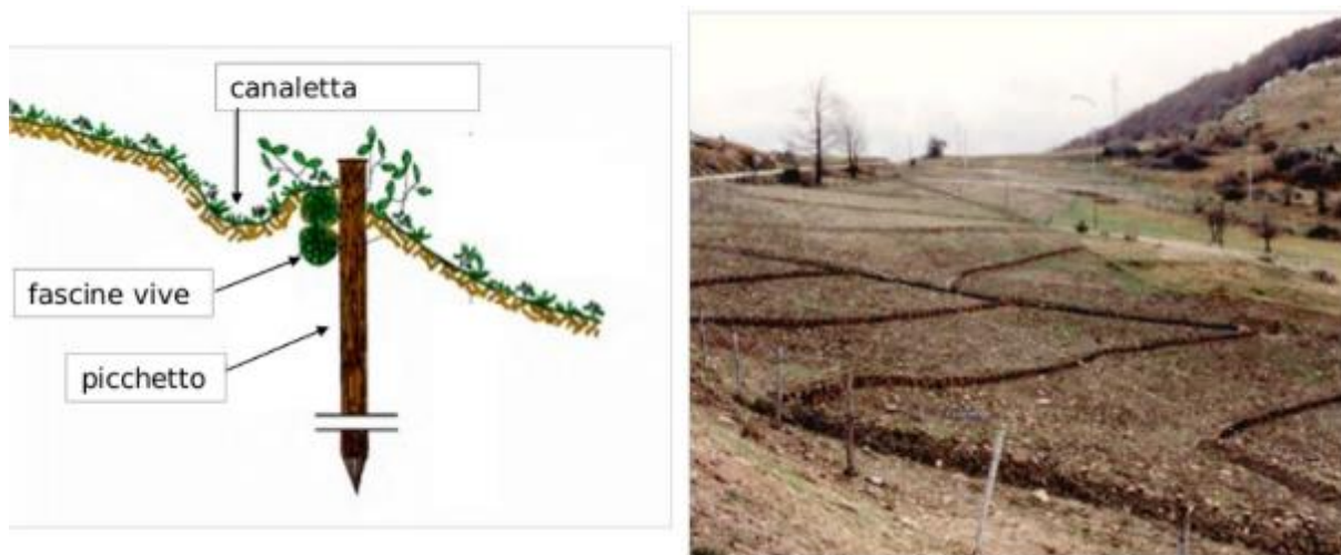
Figura 3-35 – Schema ed esempio di fascinata
