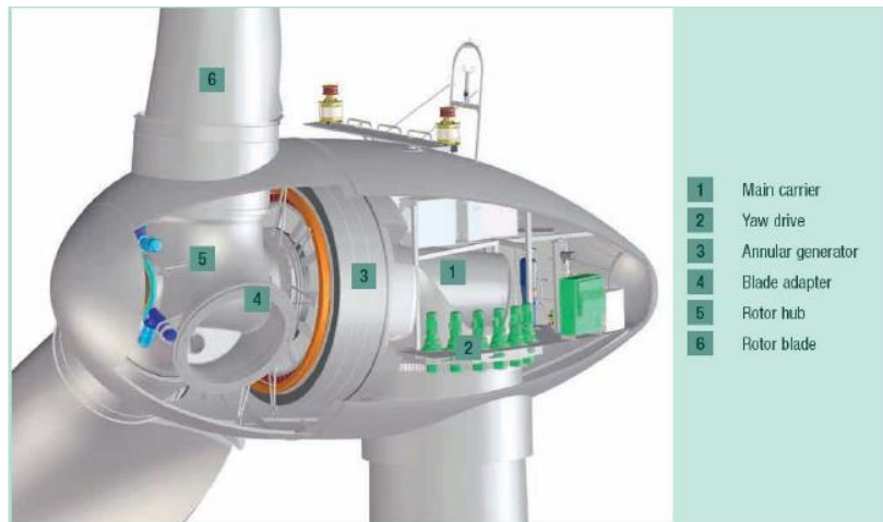
Fig. 57– Esempio degli elementi di una navicella - Fonte Enercon
