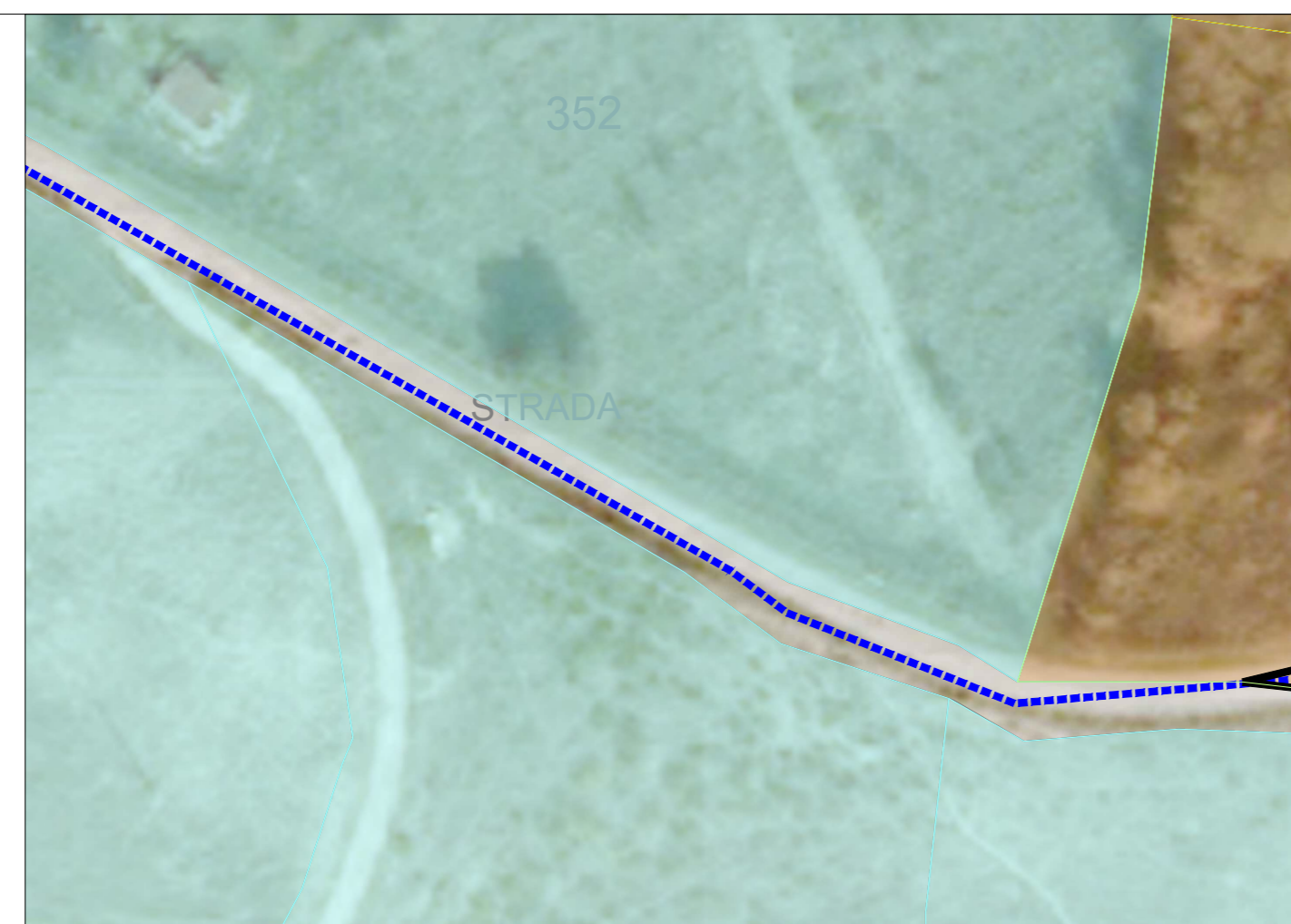
POSA DEL CAVIDOTTO INTERRATO AL DI SOTTO DELLA STRADA ESISTENTE
