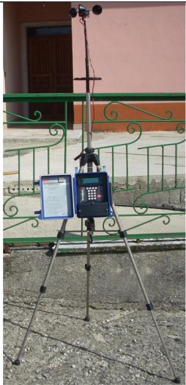
**Figura 12: Stazione meteo portatile utilizzata- l'altezza di misura dei sensori è 1,5 m; Specifiche tecniche dell'NRG #40 Maximum caratteristiche tecniche DATA LOGGER**
