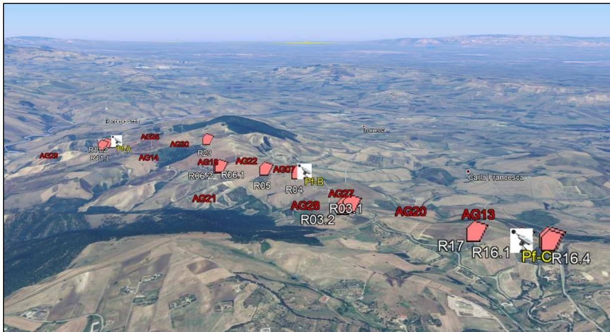
Figura 13: Individuazione dei recettori sensibili e dei fabbricati inseriti nel modello di simulazione (poligoni rosa "Rxx") ed evidenza delle postazioni fonometriche (PF con simbolo del fonometro) su ortofoto estratta da Google Earth nella forma planimetrica 2D e proposizione 3D.
