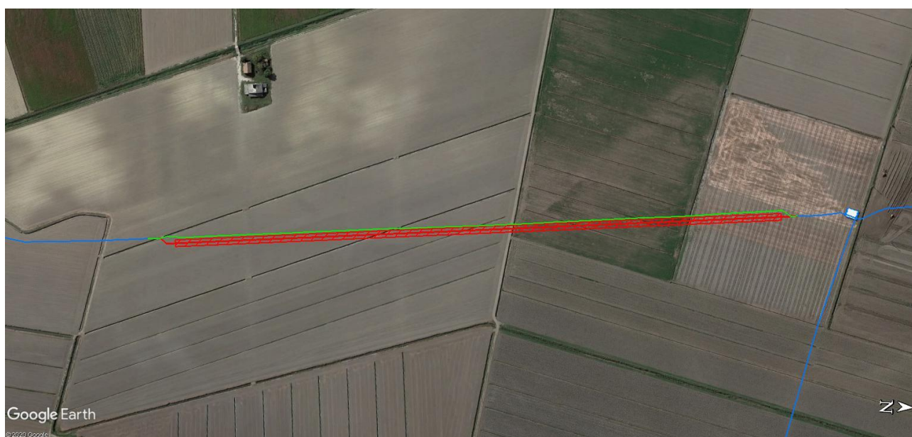
Figura 3 – Dettaglio della Variante a monte del PID 45920/5, in località “Assunteria”, nel Comune di Codigoro (FE): in rosso gli interventi in variante, in verde i tratti di linea da porre fuori esercizio e recuperare, in blu i metanodotti in esercizio.
