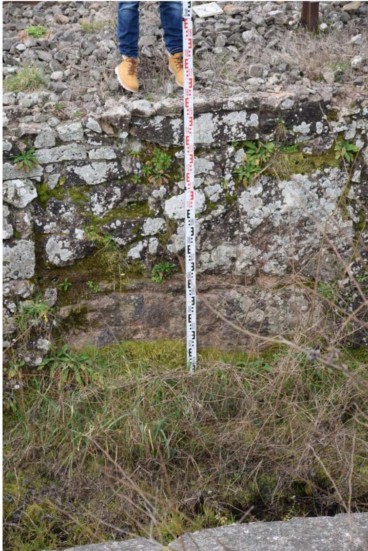
In questa immagine, scattata in corrispondenza della massicciata della ferrovia in località Bara, in corrispondenza del settore in cui si è previsto di intervenire per la messa in opera della condotta mediante spingitubo, è stata rilevata la profondità del basamento roccioso basaltico, il quale come scaturito anche dal pozzetto stratigrafico è risultato molto superficiale...
