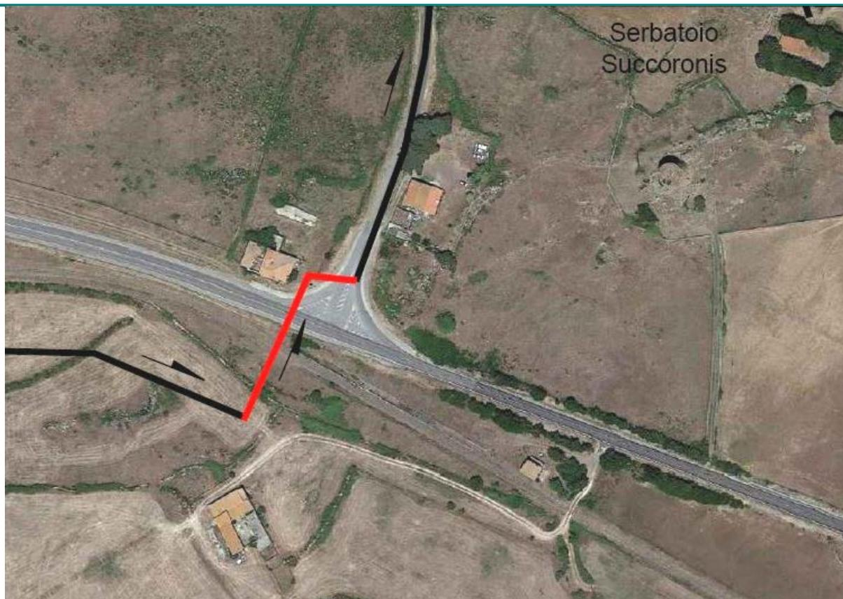
Figura 2 - Ubicazione del duplice attraversamento ferrovia Macomer-Bosa e SS129bis
