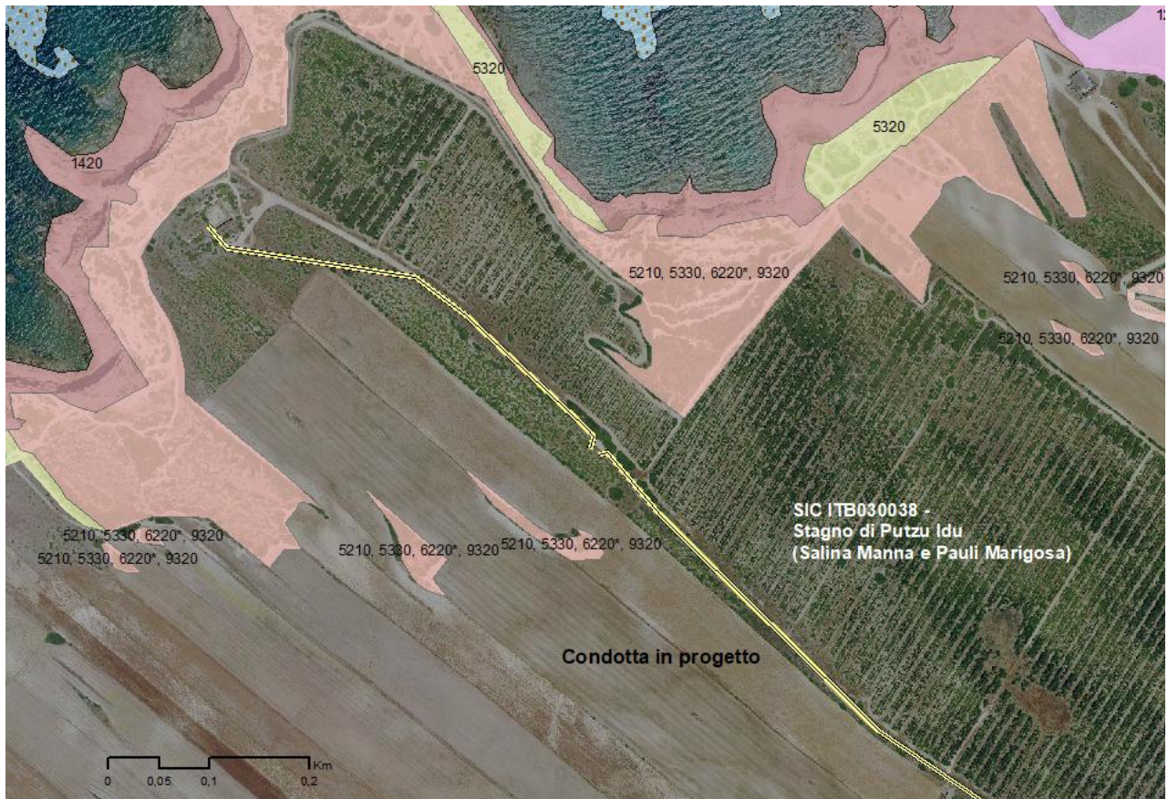
Figura 23. Interazione fra le previsioni progettuali e il SIC Stagno di Putzu Idu (Salina Manna e Pauli Marigosa) nel settore di Capo Mannu. Si può notare come la condotta in progetto attraversi il sito sfruttando in larga misura pertinenze stradali già esistenti. Si può osservare l'assenza di interazioni con Habitat di interesse comunitario (Fonte: aggiornamento cartografico 2014 degli Habitat dei siti Natura 2000)
