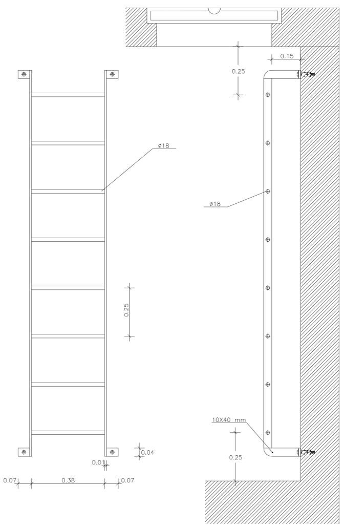
POZZETTO DI MANOVRA O SCARICO FORZATO DELLE DIMENSIONI INTERNE (1,90X2,20X2,00) PER CONDOTTE DI DIAMETRO  $\phi 250-350$  mm
