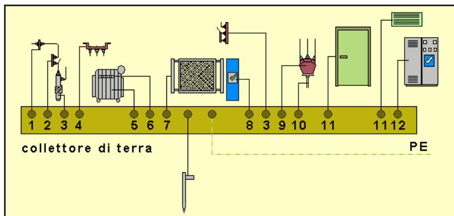
**Figura 9-2 – Esempi di collegamenti a terra in cabina**
