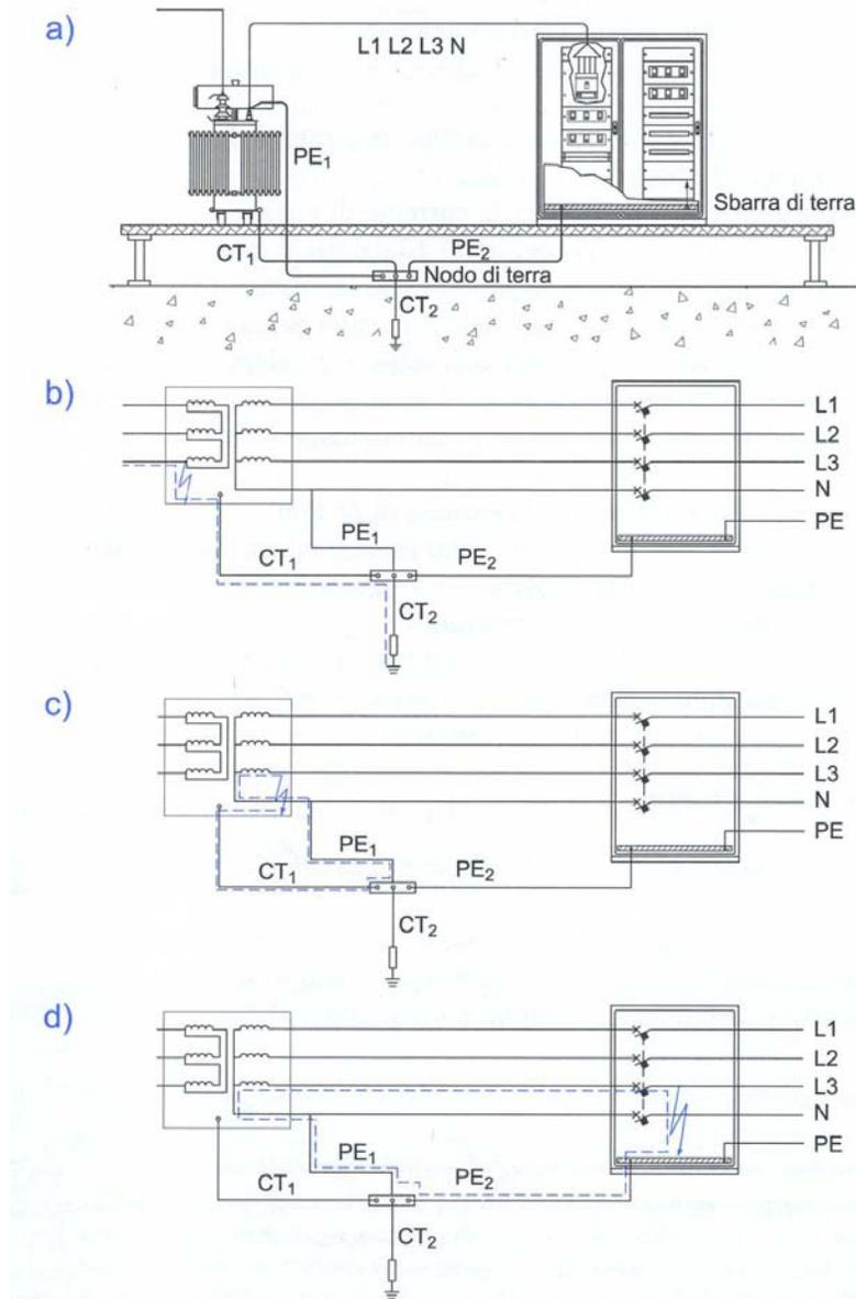
**Figura 9-3 - Collegamenti a terra in cabina**
