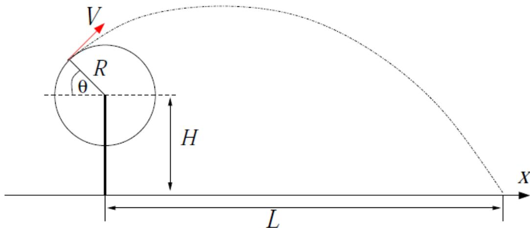
Figura 3 - Schema adottato per il calcolo della gittata
