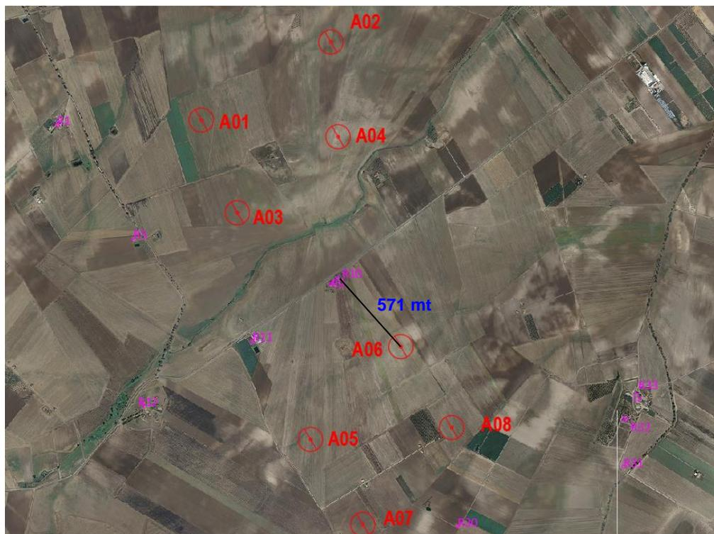
**Figura 5:** Distanze minime degli aerogeneratori dai recettori
