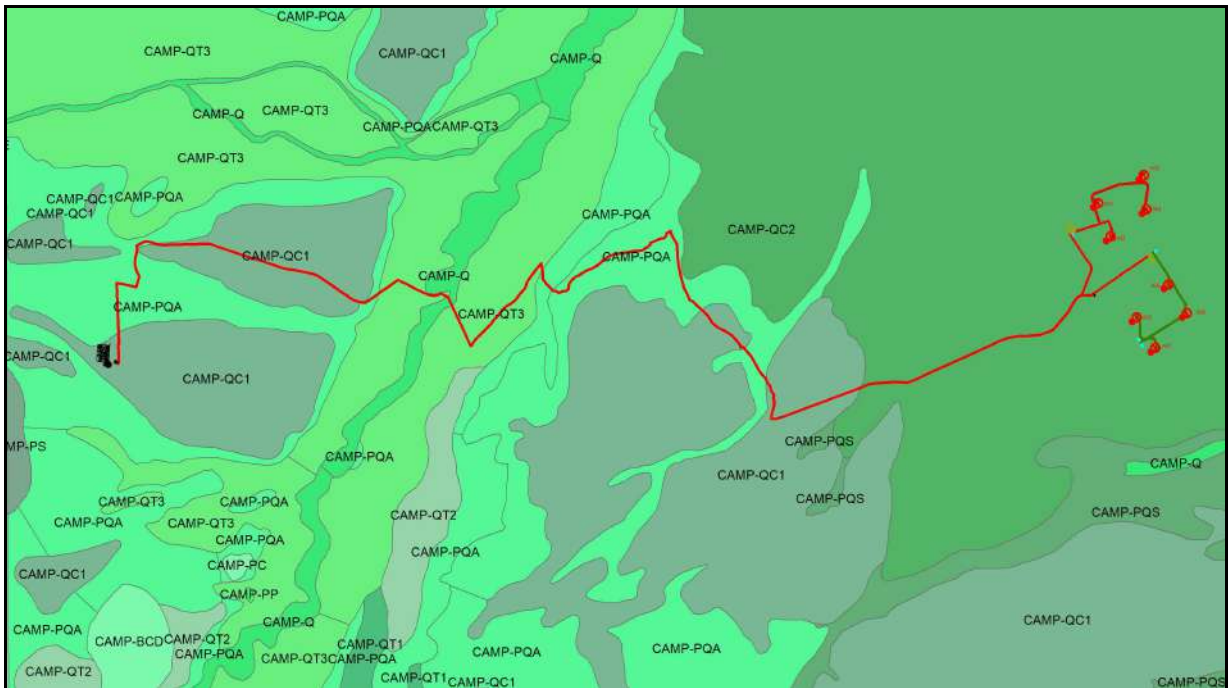
Fig. 4: localizzazione delle opere in progetto (in azzurro) in relazione alla Carta Geologica d'Italia.
