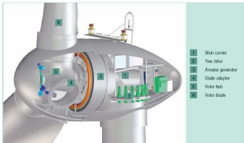
Fig. 69 - Elementi di una navicella - Fonte Enercon
